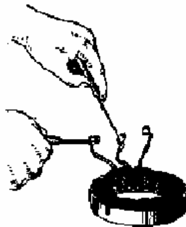
Рис. 6.9. Проверка обмоток статора на обрыв цепи
