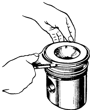
Рис. 85. Снятие и надевание поршневых колец
