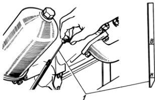
Рис. 3. Проверка уровня масла: 1 - указатель уровня масла
