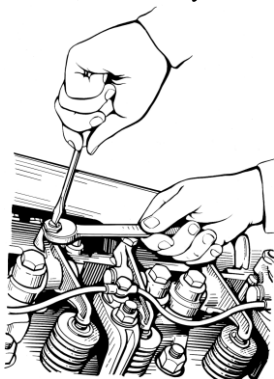
Рис. 16. Отвертывание контргайки регулировочного винта
