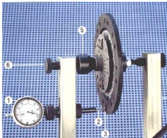
Рис.109. Проверка биения рабочей поверхности ведомого диска.
