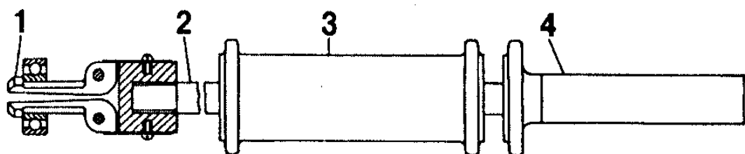
Рис.53. Съемник 7823-6090 для выпрессовки подшипника первичного вала коробки передач из коленчатого вала:
