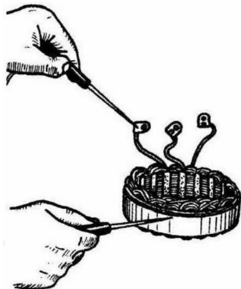
Рис.52. Проверка отсутствия замыкания катушек статора на корпус
