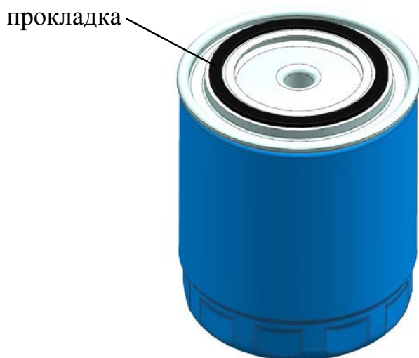
Рис.223. Прокладка масляного фильтра:
