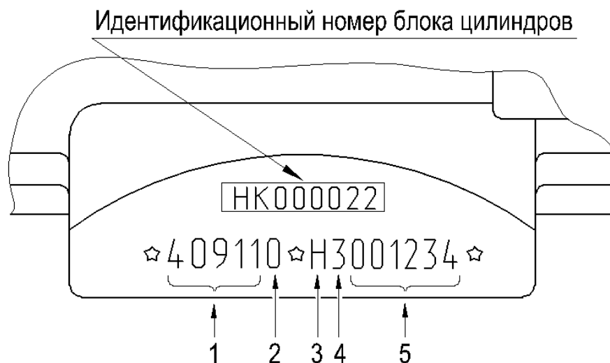
Рис.11. Идентификационный номер двигателя:
