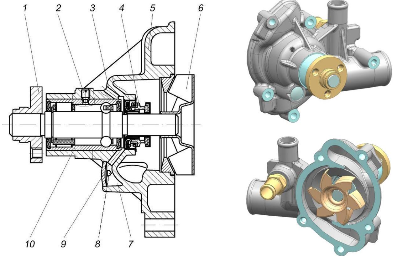
Рис.43. Водяной насос:
