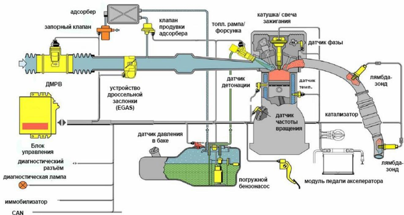
Рис.54. Принципиальная схема системы управления двигателями ЗМЗ-40904.10
