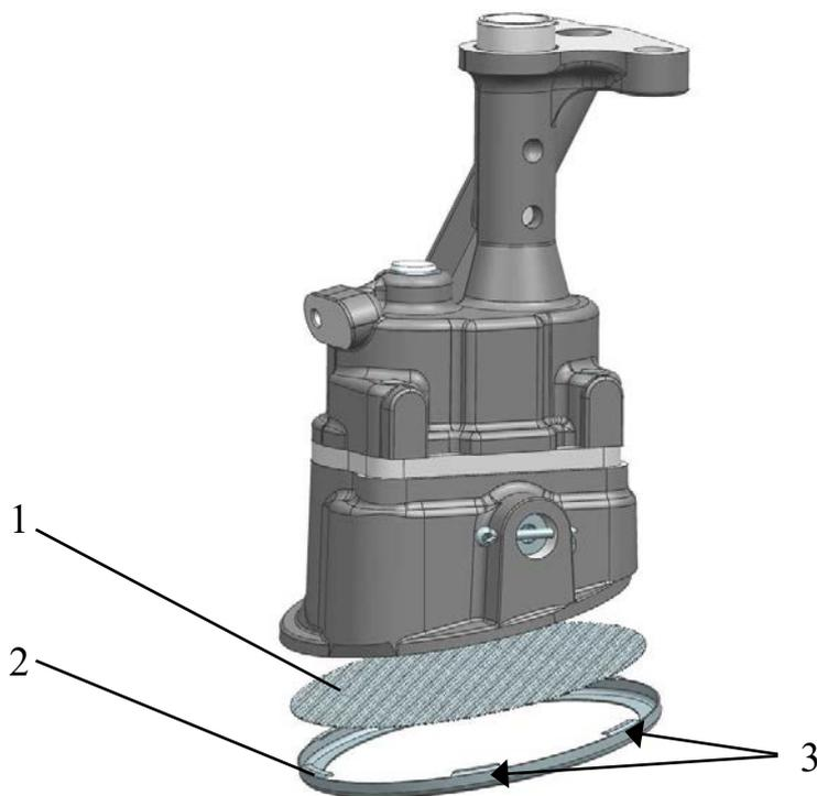
Рис.109. Снятие каркаса с сеткой с приемного патрубка масляного насоса:
