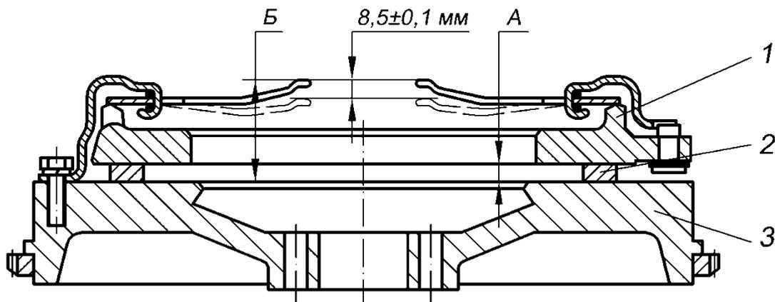
Рис.136. Регулировка концов лепестков и проверка нажимного диска сцепления:
