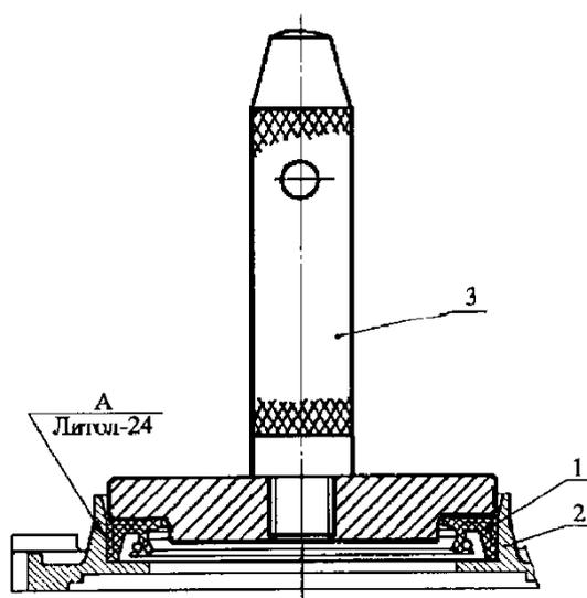
Рис.116. Запрессовка сальника в сальникодержатель:
