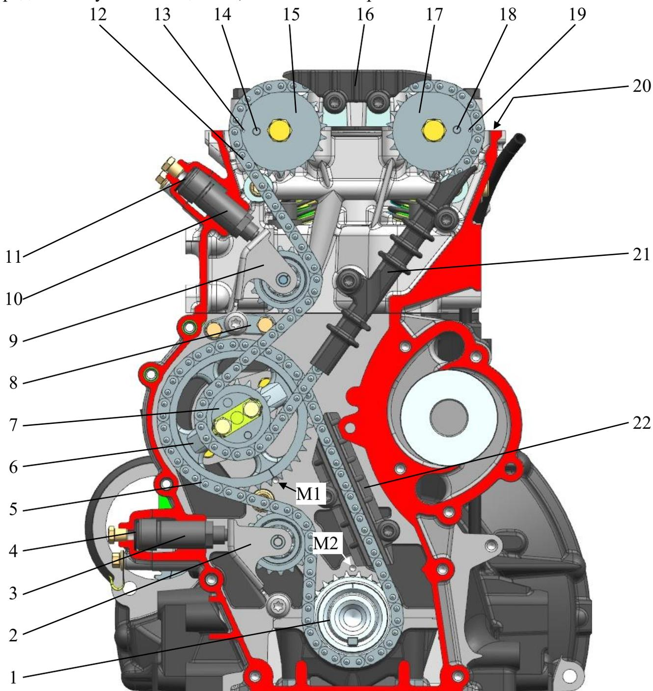
Рис.28. Привод распределительных валов двигателей ЗМЗ-40904.10 с втулочными двухрядными и однорядными цепями:
