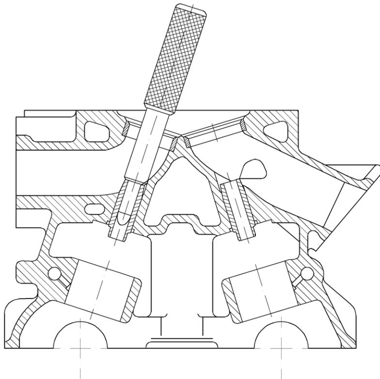
Рис.85. Выпрессовка втулки клапана
