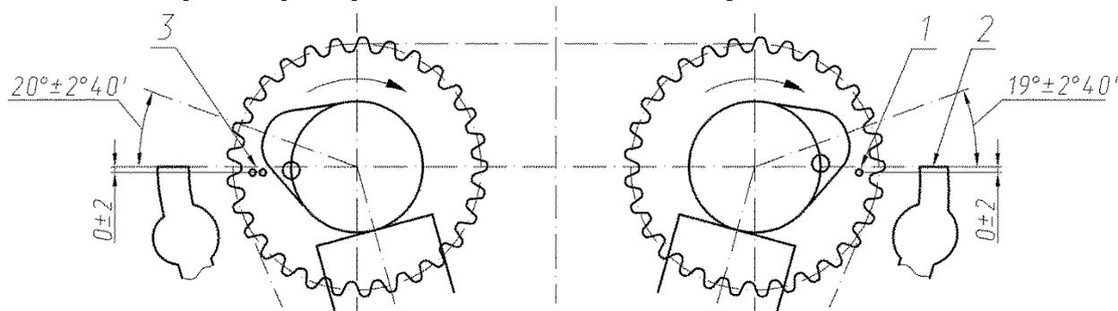
Рис.92. Схема положения распределительных валов при положении поршня первого цилиндра в ВМТ такта сжатия:
