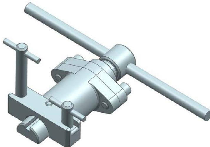
Рис.157. ЗМ 7823-4815, Приспособление для снятия масляного картера
