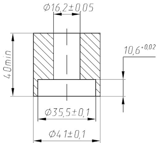
Рис.104. Оправка для запрессовки уплотнения
