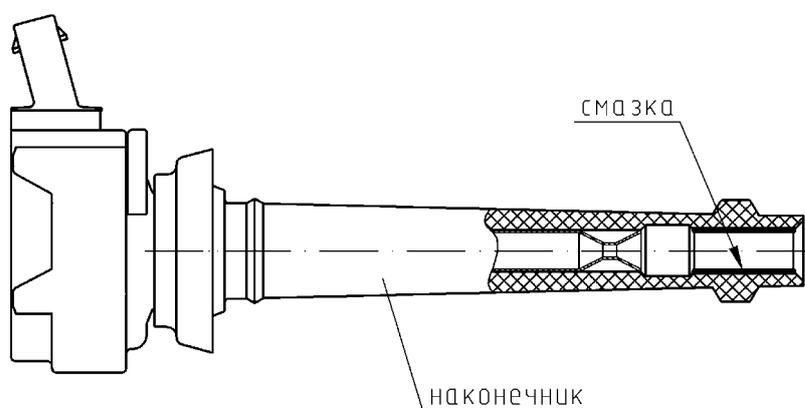
Рис.74. Нанесение смазки на наконечник катушки зажигания
