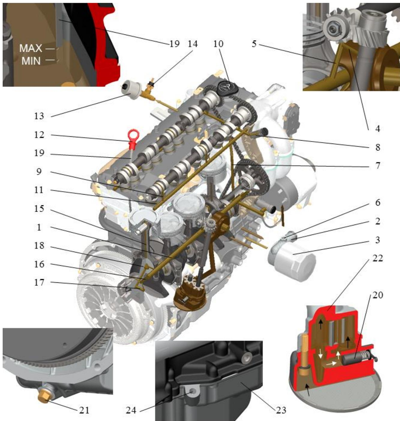
Рис.35. Схема системы смазки:
