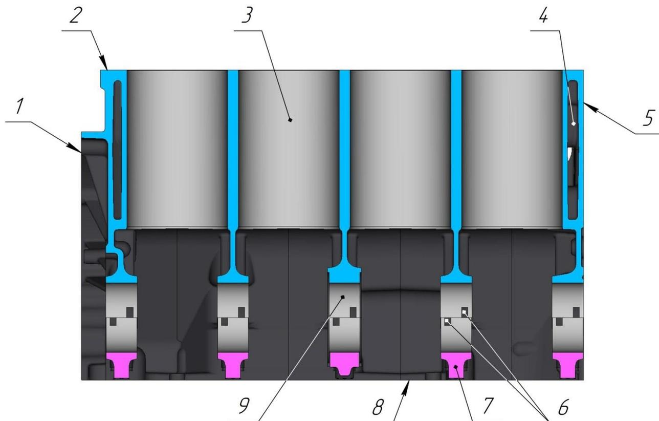
Рис.19. Блок цилиндров. Продольный разрез по оси цилиндров:
