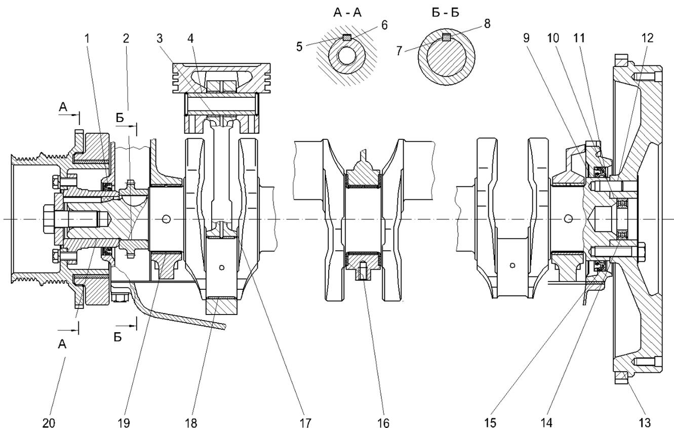
Рис.138. Кривошипно-шатунный механизм
