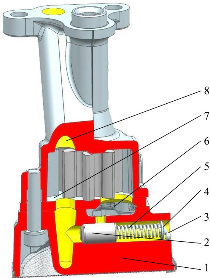
Рис.37. Разрез масляного насоса по редукционному клапану:
