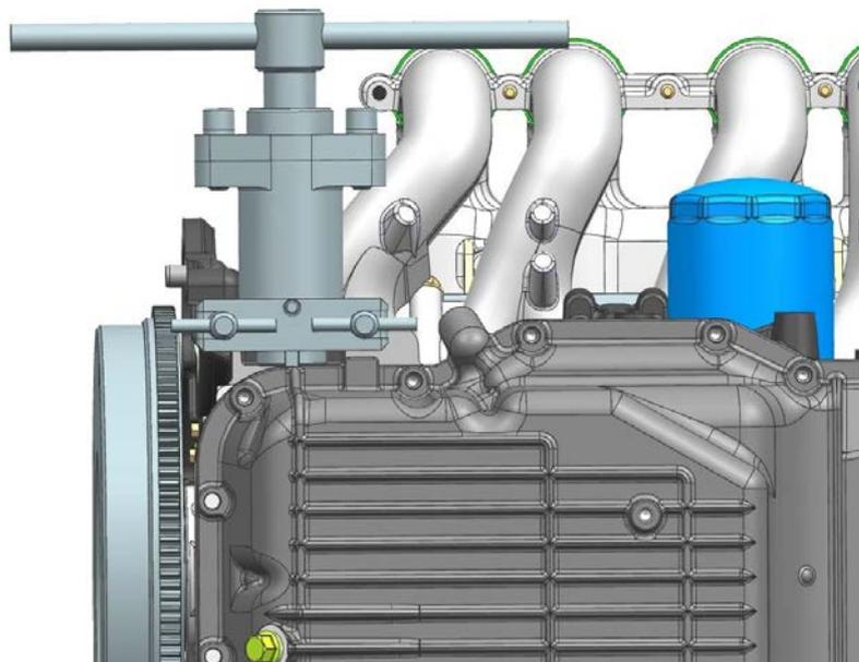
Рис.158. Установка приспособления ЗМ 7823-4815 на двигателе
