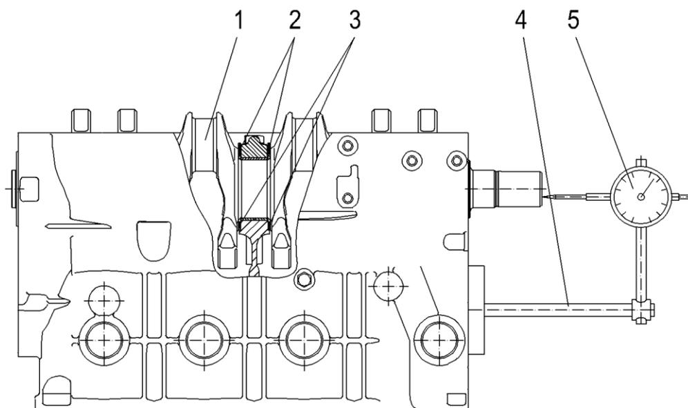
Рис.115. Проверка осевого зазора коленчатого вала:
