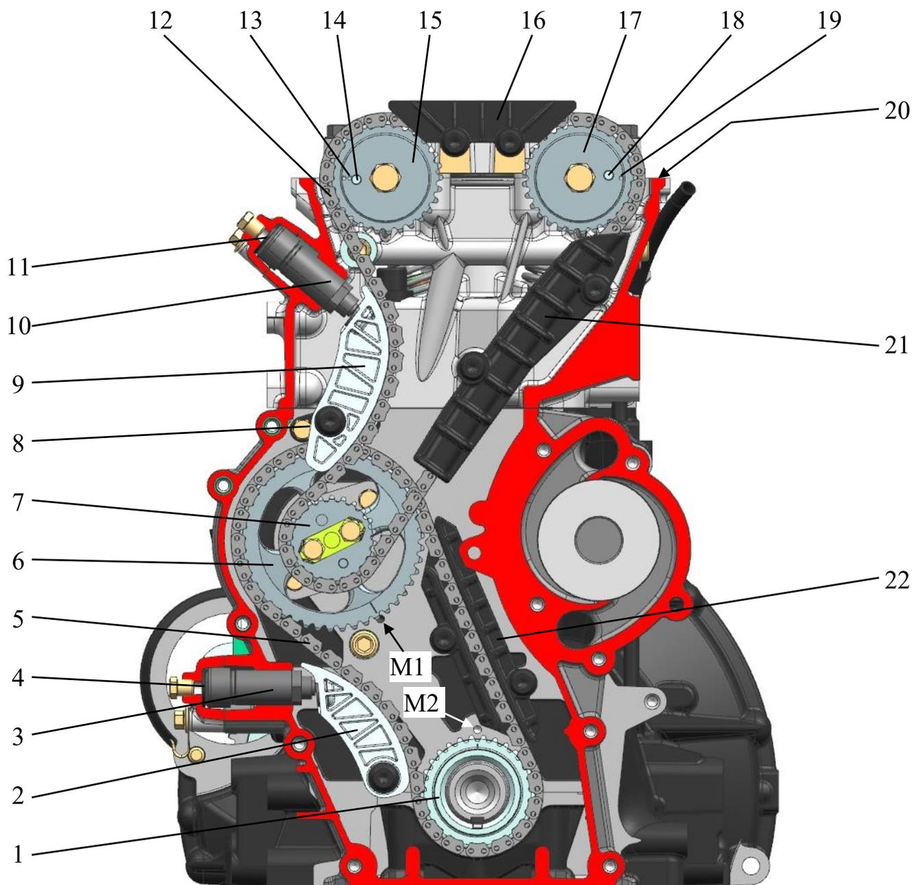
Рис.27. Привод распределительных валов с зубчатыми цепями:
