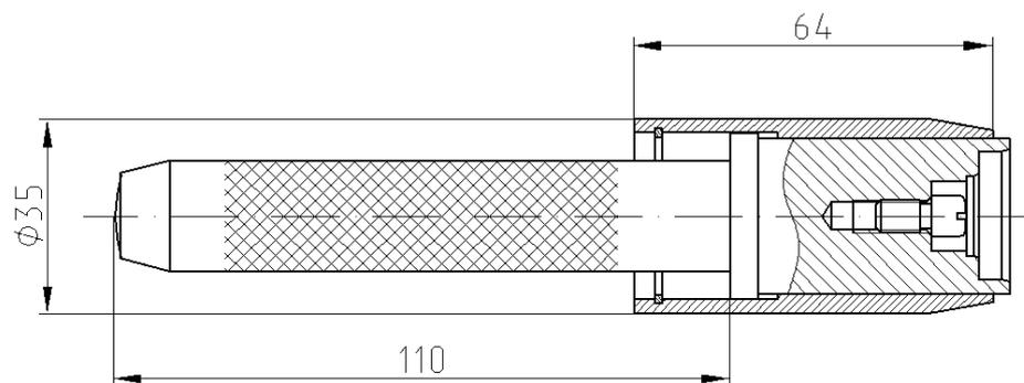
Рис.154. ЗМ 7853-4355, Оправка для напрессовки
