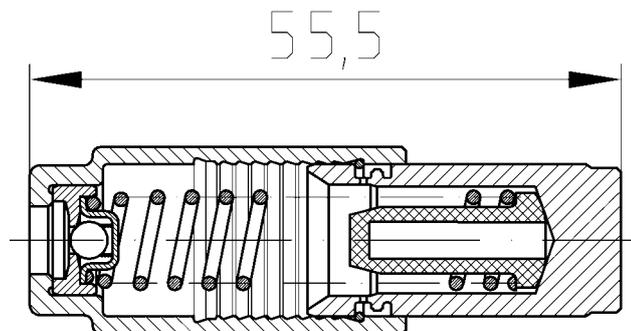
Рис.96. Гидронатяжитель с полностью выдвинутым плунжером
