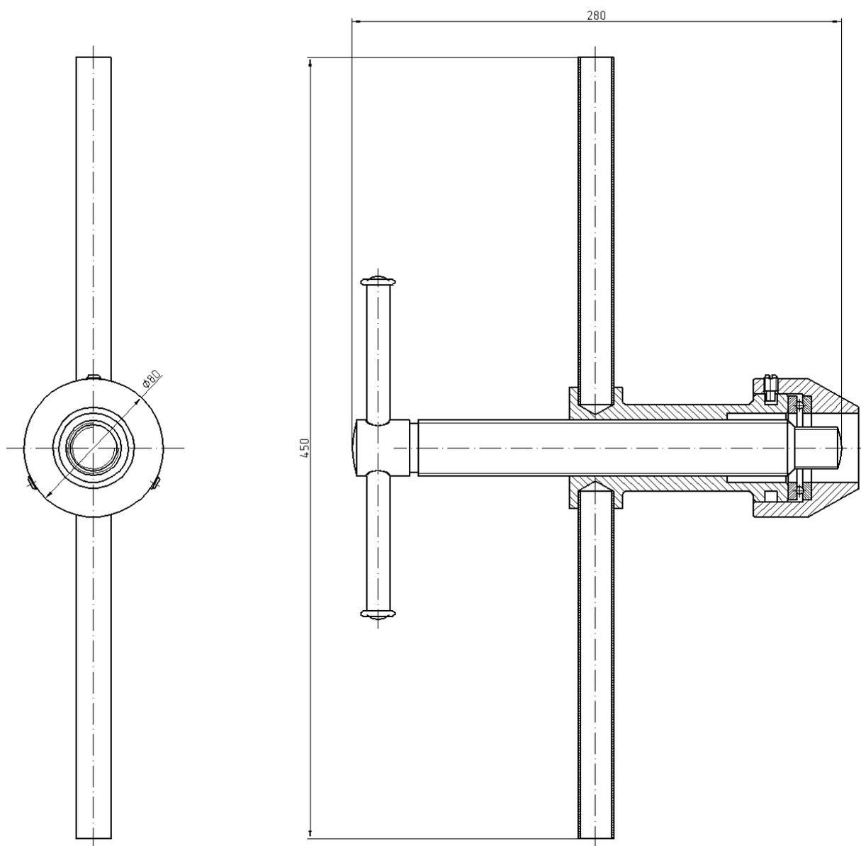
Рис.144. ЗМ 7823-4291-01, Приспособление для напрессовки звездочки и ступицы на коленчатый вал
