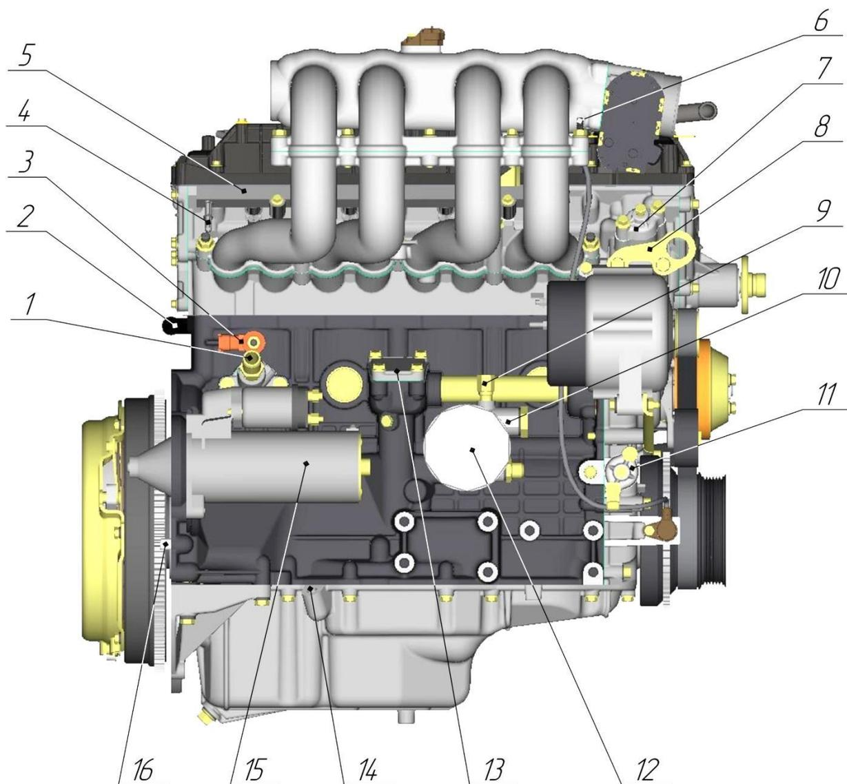
Рис.12. Вид слева двигателя ЗМЗ-40905.10:
