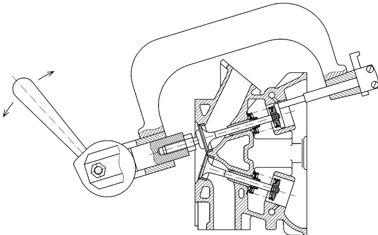
Рис.82. Снятие клапанных пружин
