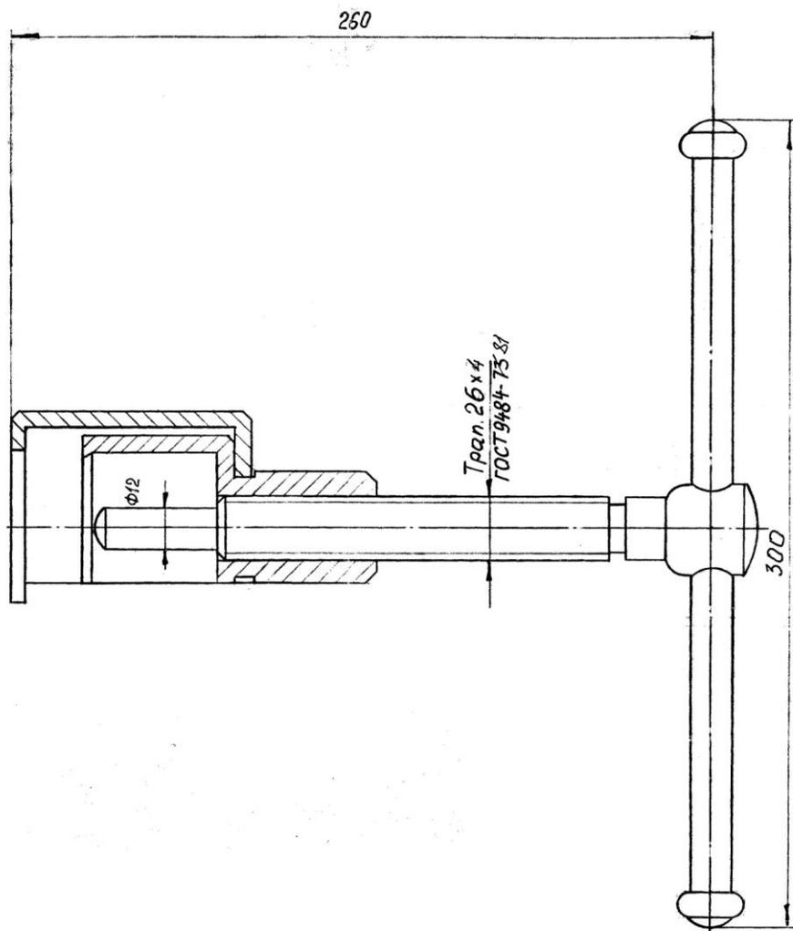
Рис.145. ЗМ 7814-5118, Съемник звездочки 40904.1005033 и втулки коленчатого вала
