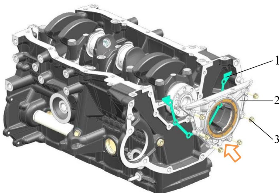
Рис.117. Установка сальникодержателя:
