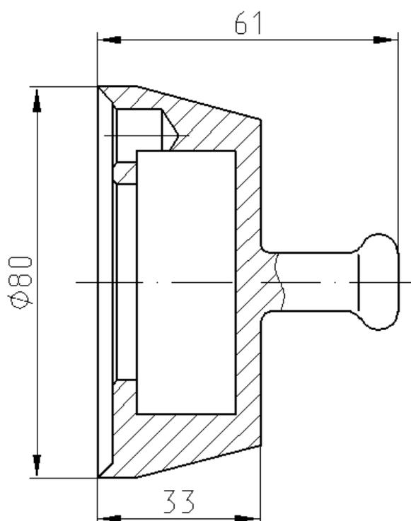
Рис.155. ЗМ 7853-4215, Оправка для установки сальникодержателя
