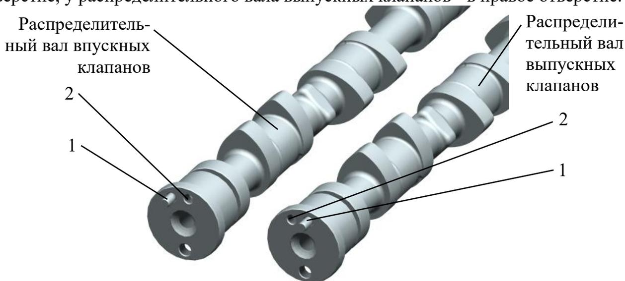
Рис.126. Распределительные валы впускных и выпускных клапанов:
