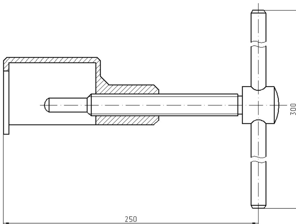
Рис.146. ЗМ 7814-5118-01, Съемник звездочки 406.1005033-10 коленчатого вала
