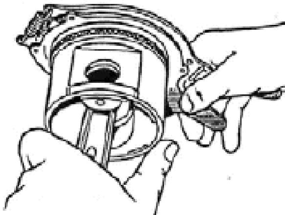
Рис.123. Установка поршневых колец на поршень
