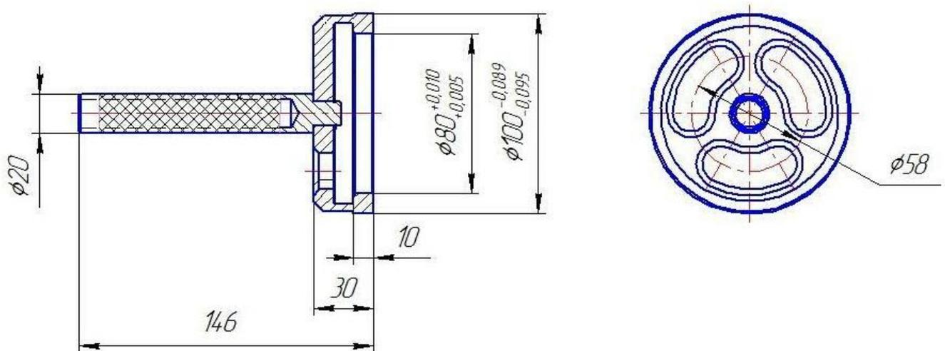
Рис.159. ЗМ 7853-4418, Оправка для центрирования заднего сальника в сборе с сальникодержателем относительно заднего фланца коленчатого вала
