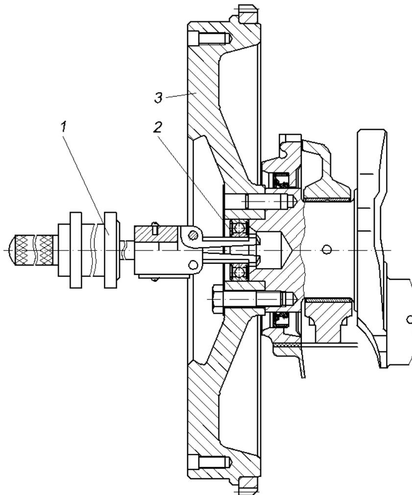
Рис.77. Снятие подшипника первичного вала коробки передач:
