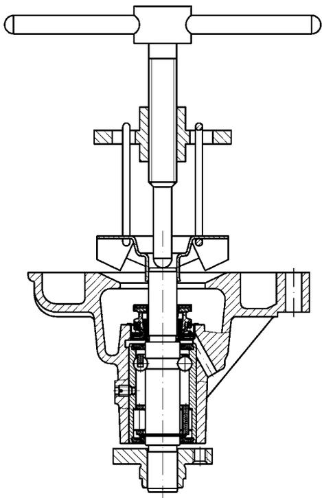
Рис.98. Снятие крыльчатки
