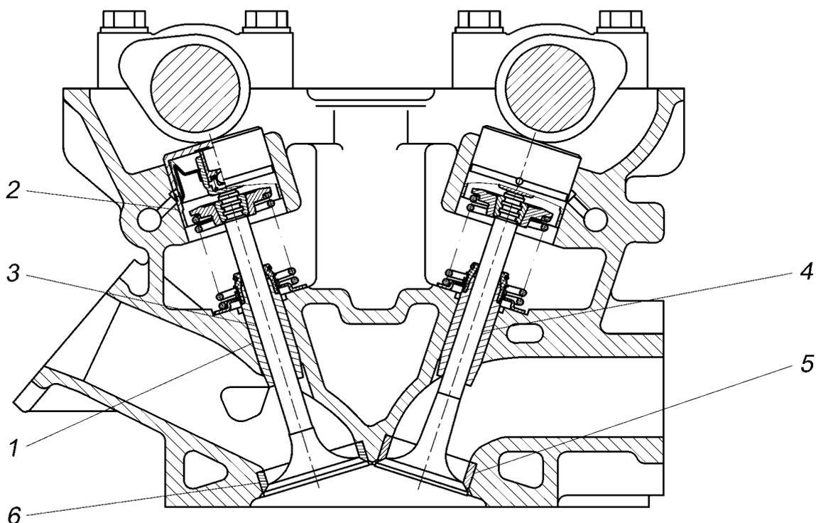
Рис.139. Привод клапанов
