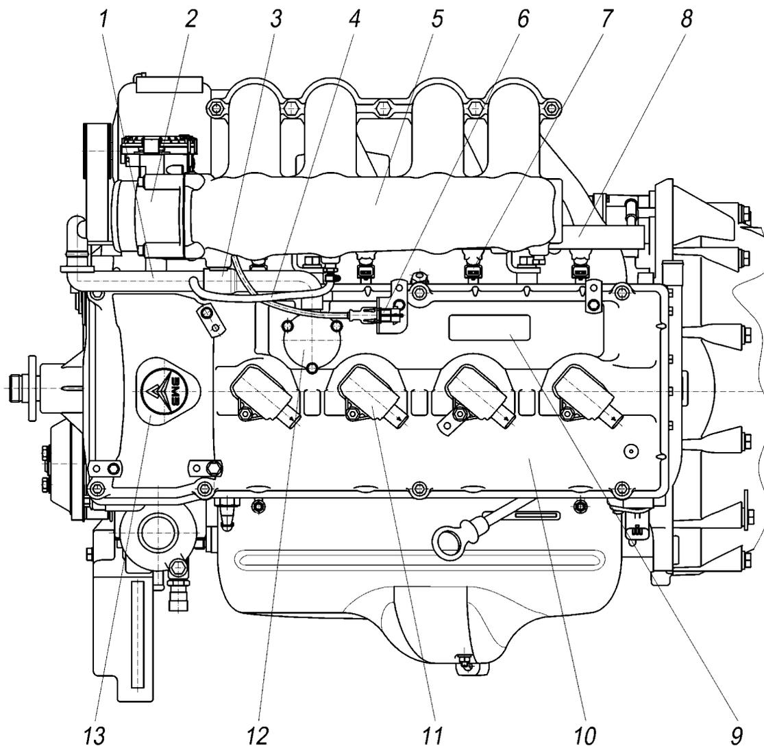
Рис.7. Вид двигателя ЗМЗ-40904.10 сверху:
