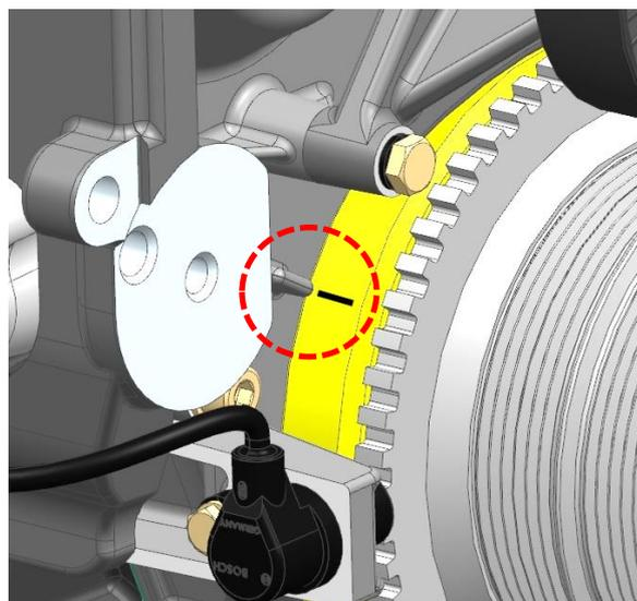
Рис.90. Риска на шкиве коленчатого вала и указатель на крышке цепи
