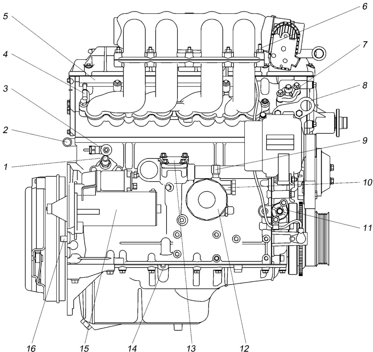
Рис.6. Вид слева двигателя ЗМЗ-40904.10:
