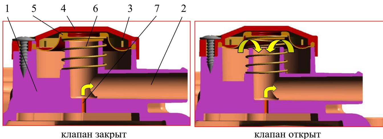
Рис.53. Клапан разрежения:
