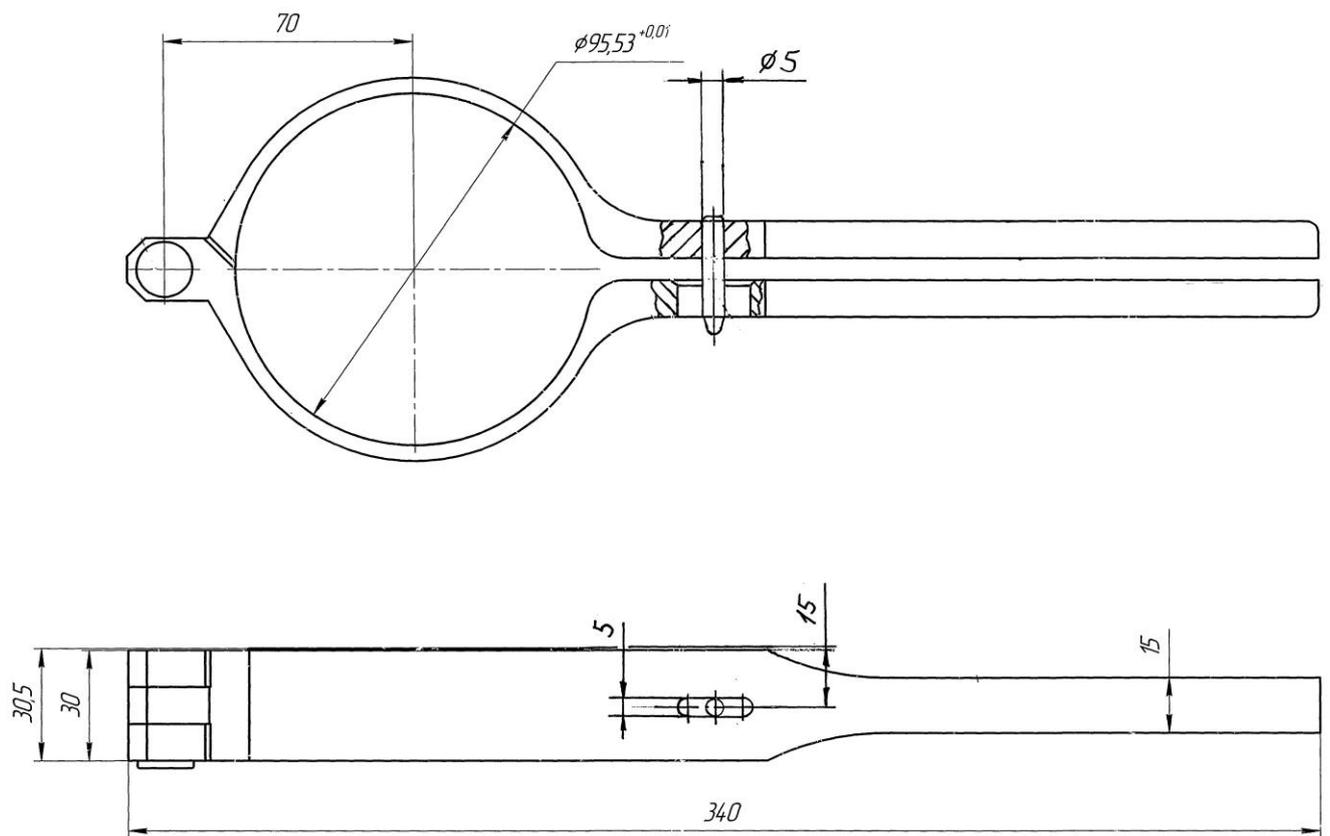
Рис.149. ЗМ 7820-4517, Оправка для сжатия поршневых колец  $\text{Ø} 95,5 \text{ мм}$
