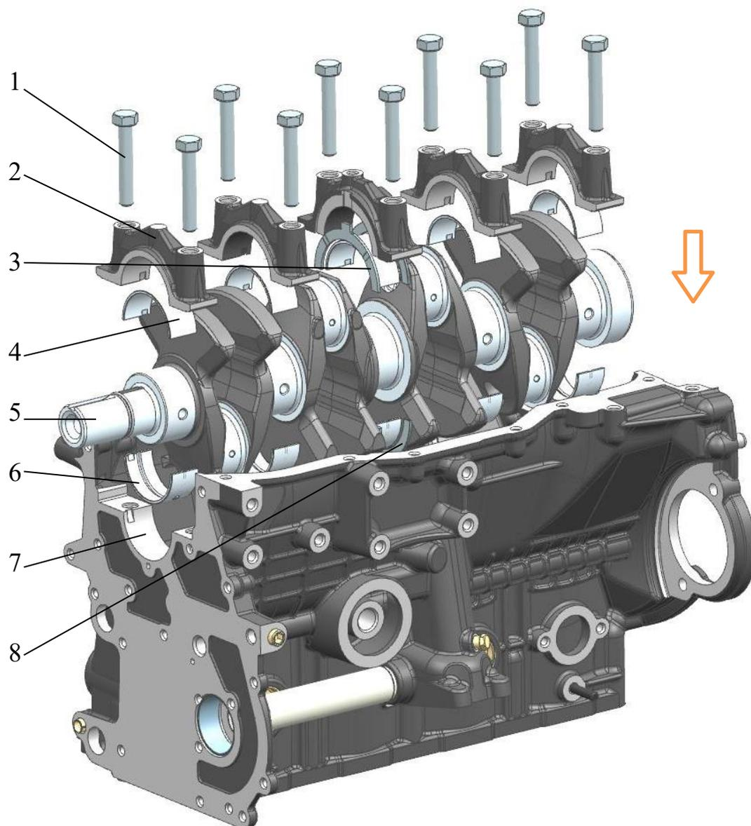
Рис.114. Установка коленчатого вала:
