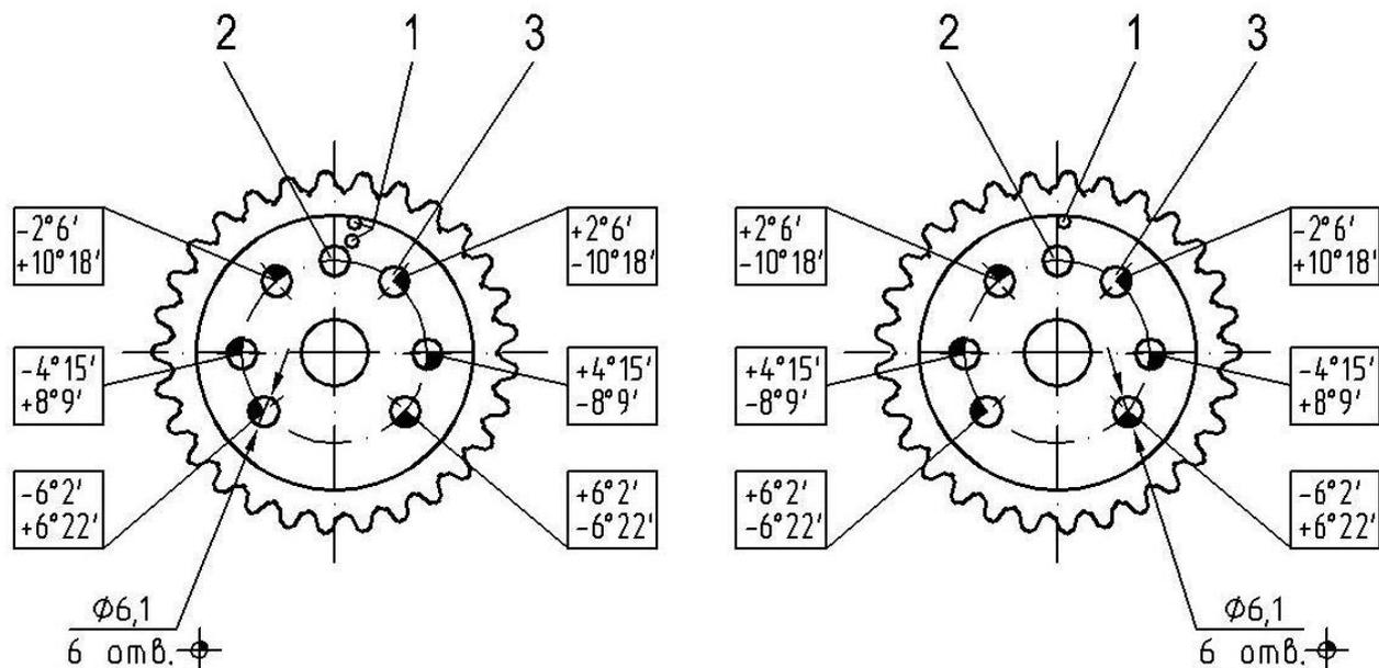
Рис.94. Дополнительные установочные отверстия в звездочках:
