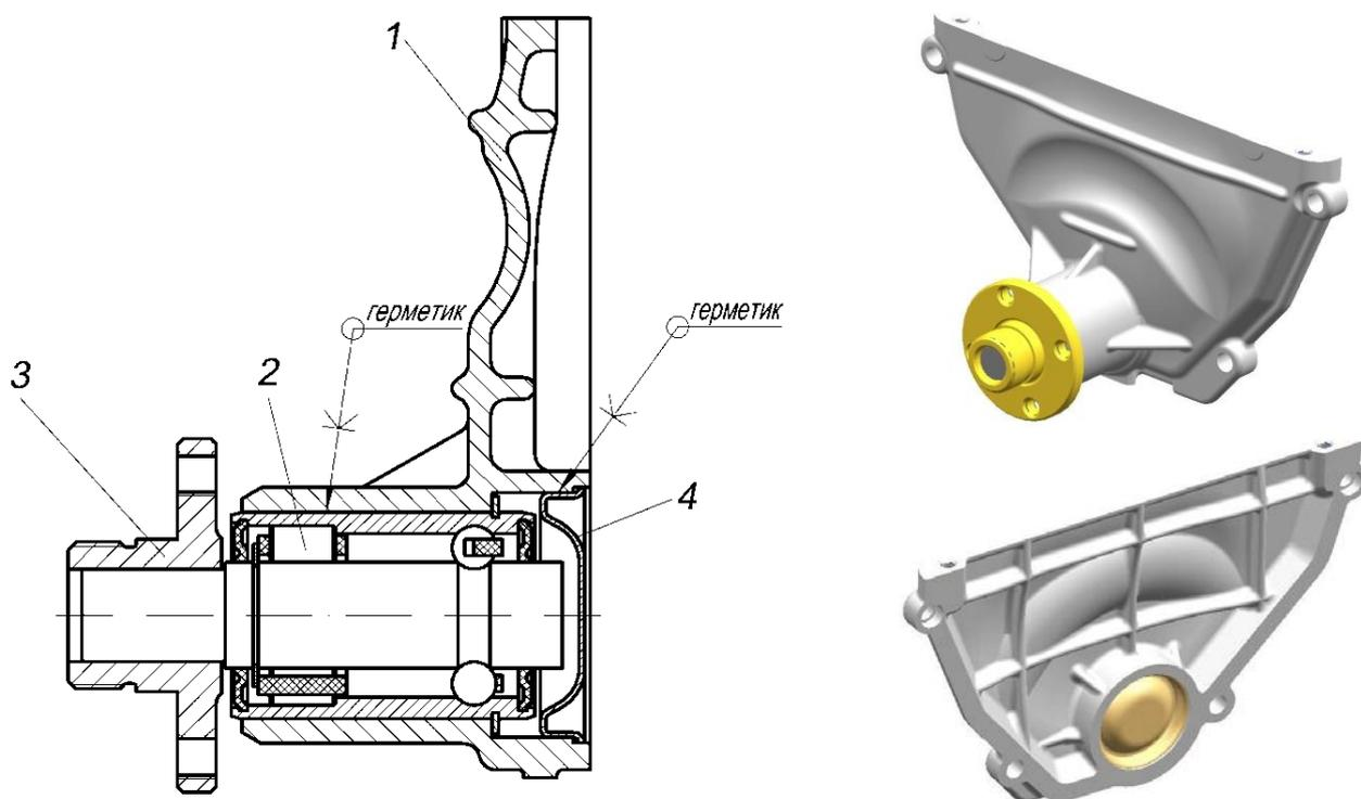
Рис.45. Опора вентилятора:
