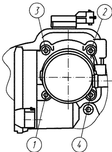
Рис.131. Последовательность затяжки винтов крепления дроссельного модуля
