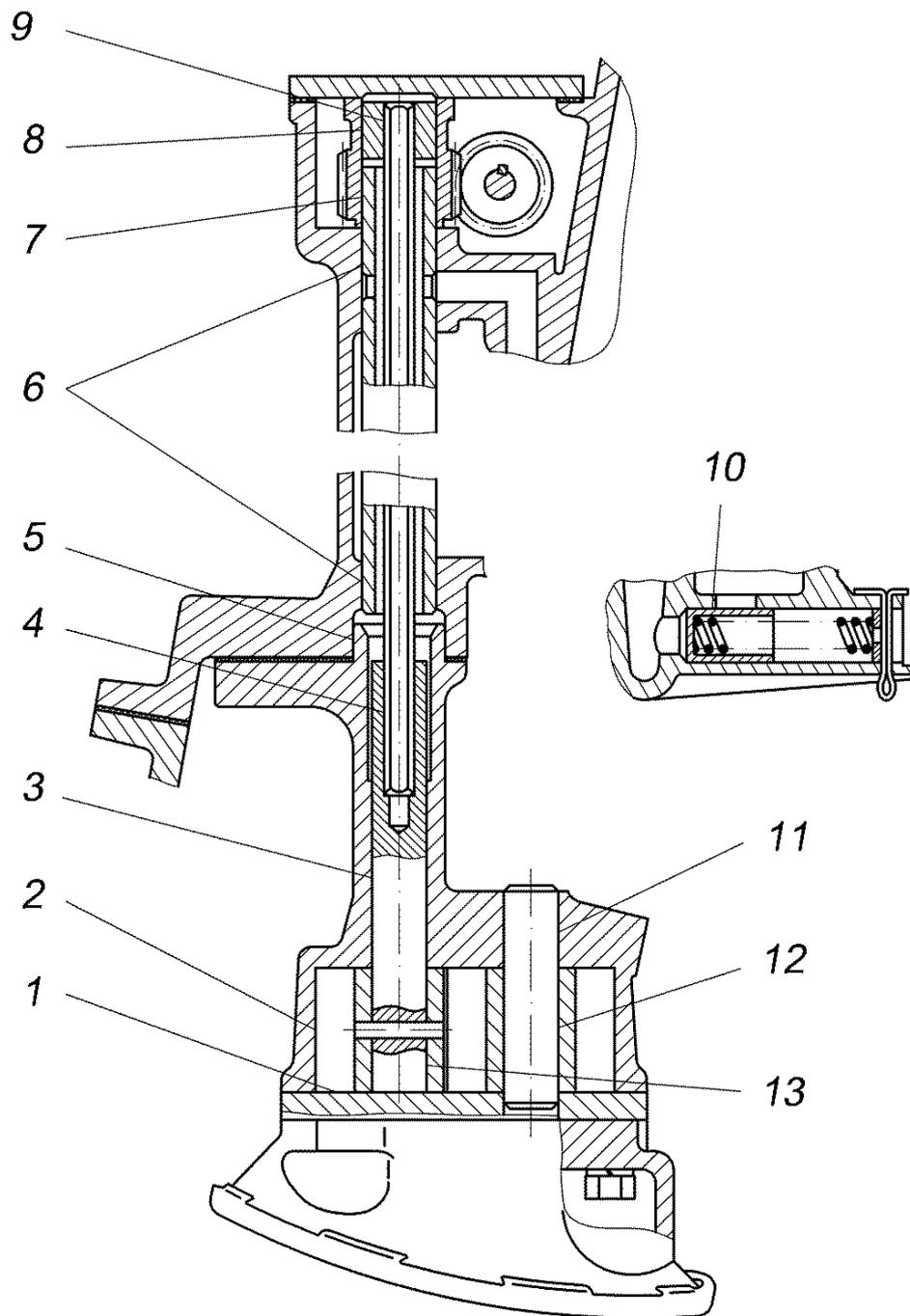
Рис.141. Масляный насос, редукционный клапан и привод масляного насоса
