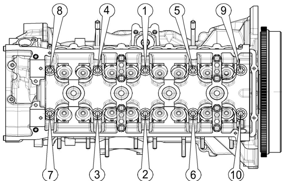
Рис.125. Последовательность затяжки болтов крепления головки цилиндров
