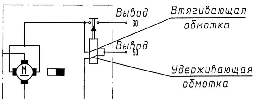
Рис.70. Электрическая схема подключения стартера
