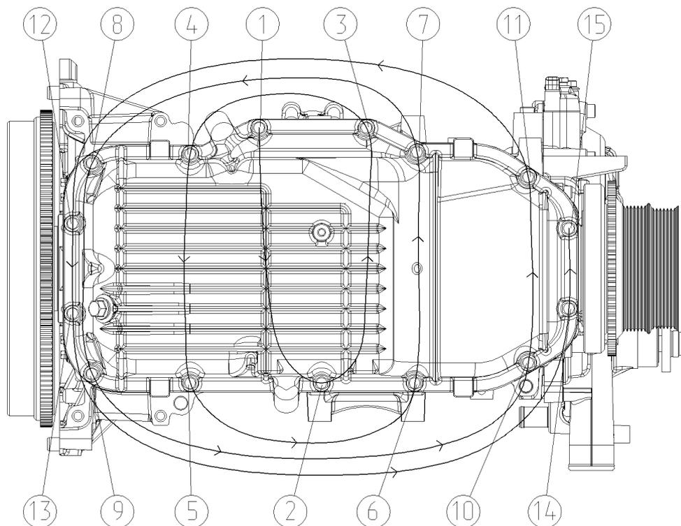
Рис.129. Последовательность затяжки болтов масляного картера
