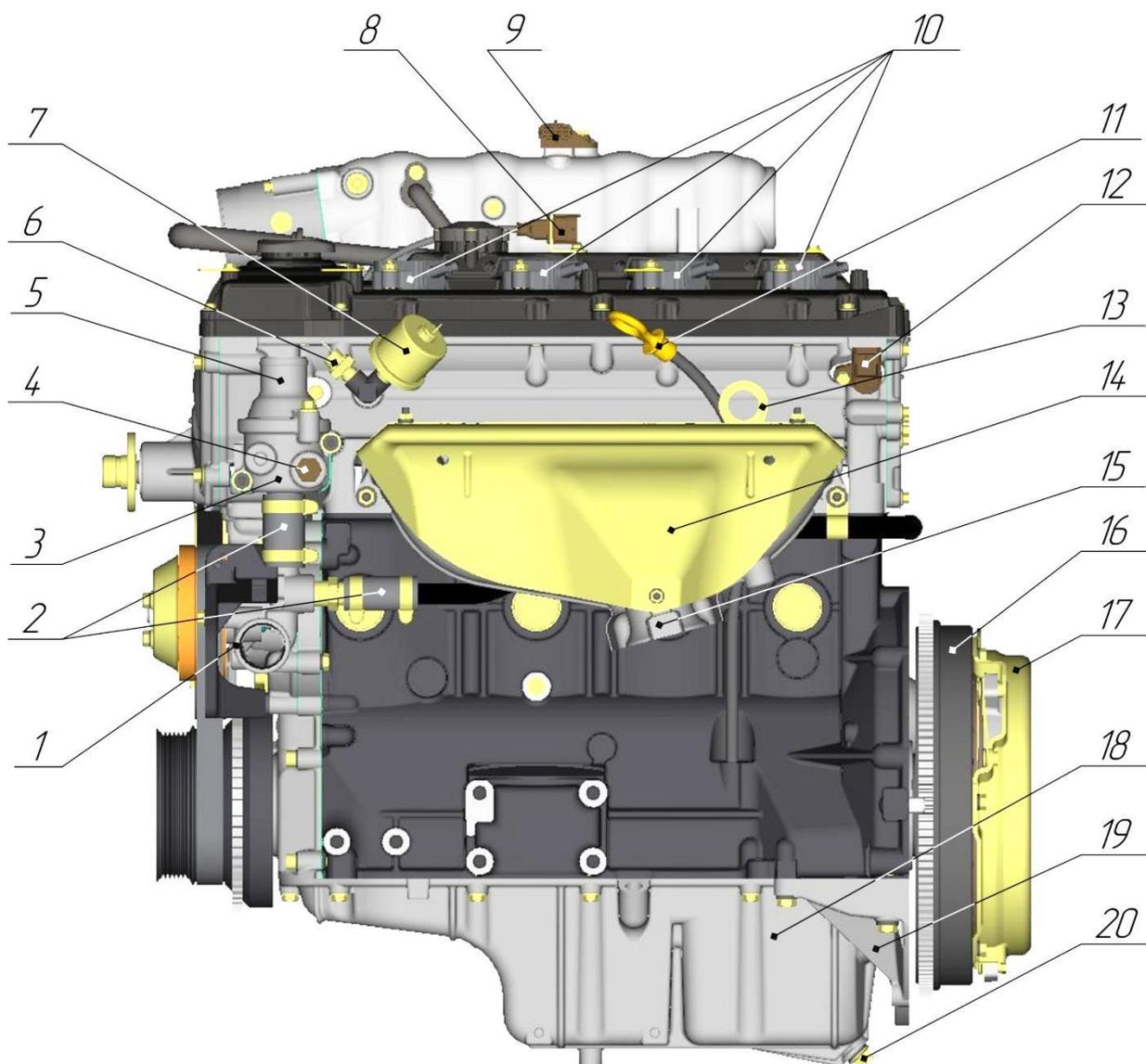
Рис.11. Вид справа двигателя 3МЗ-40905.10:
