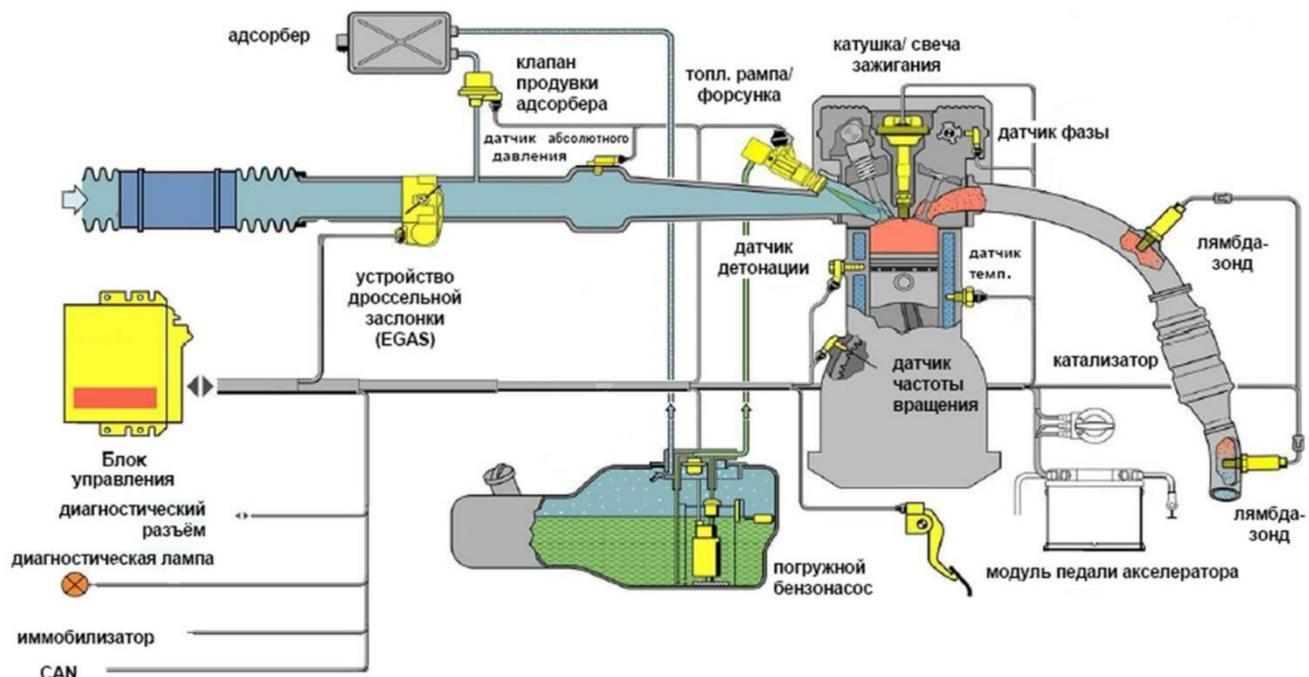
Рис.55. Принципиальная схема системы управления двигателями ЗМЗ-40905.10
