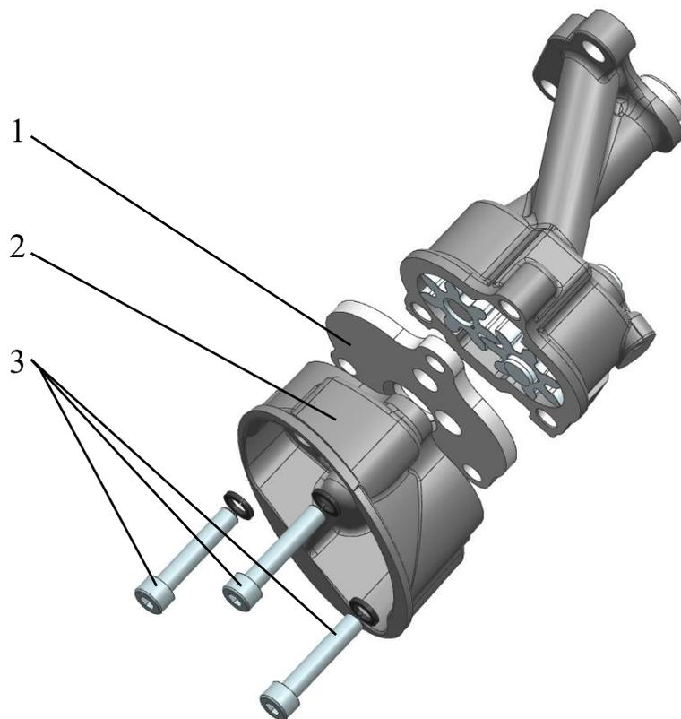
Рис.110. Снятие приёмного патрубка с перегородкой масляного насоса:
