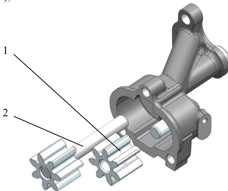
Рис.111. Снятие шестерен масляного насоса:
