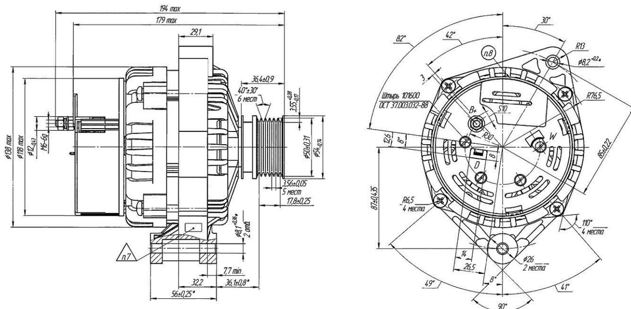
Рис.68. Габаритные размеры генератора 3212.3771000-10 ОАО «БАТЭ»
