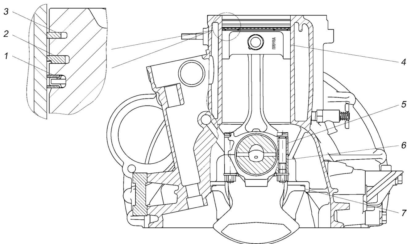
Рис.137. Блок цилиндров и поршень
