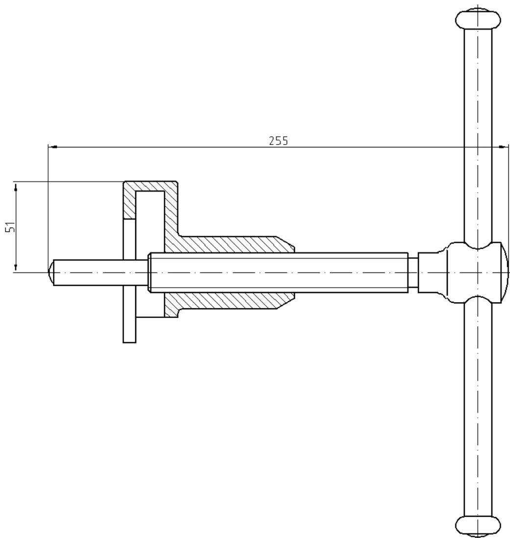
Рис.153. ЗМ 7814-5111, Съемник для снятия ступицы шкива коленчатого вала
