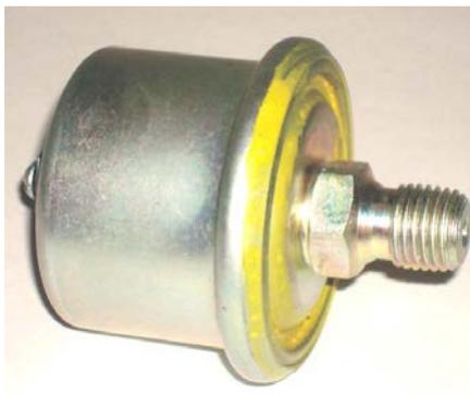
Рис.71. Датчик указателя давления масла
