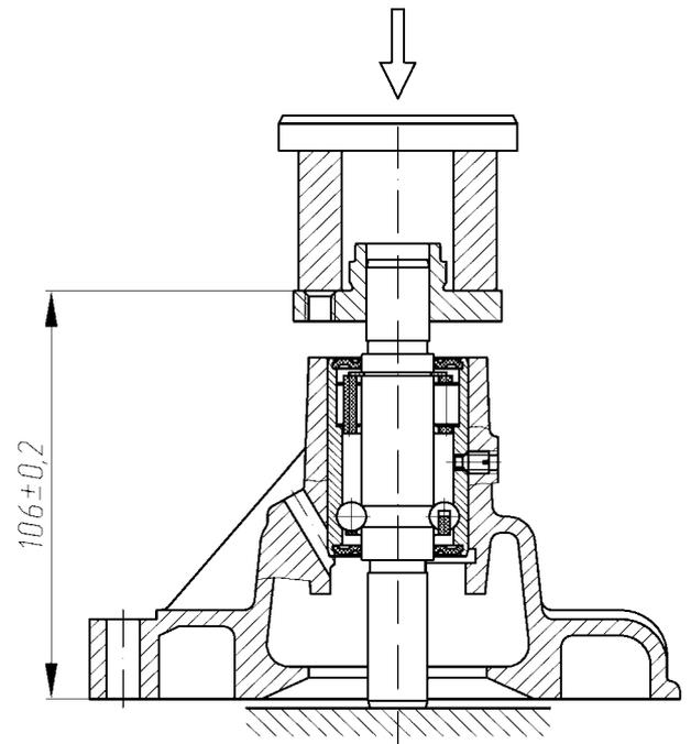
Рис.105. Напрессовка ступицы шкива водяного насоса
