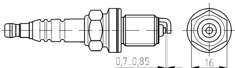
Рис.59. Свеча зажигания
