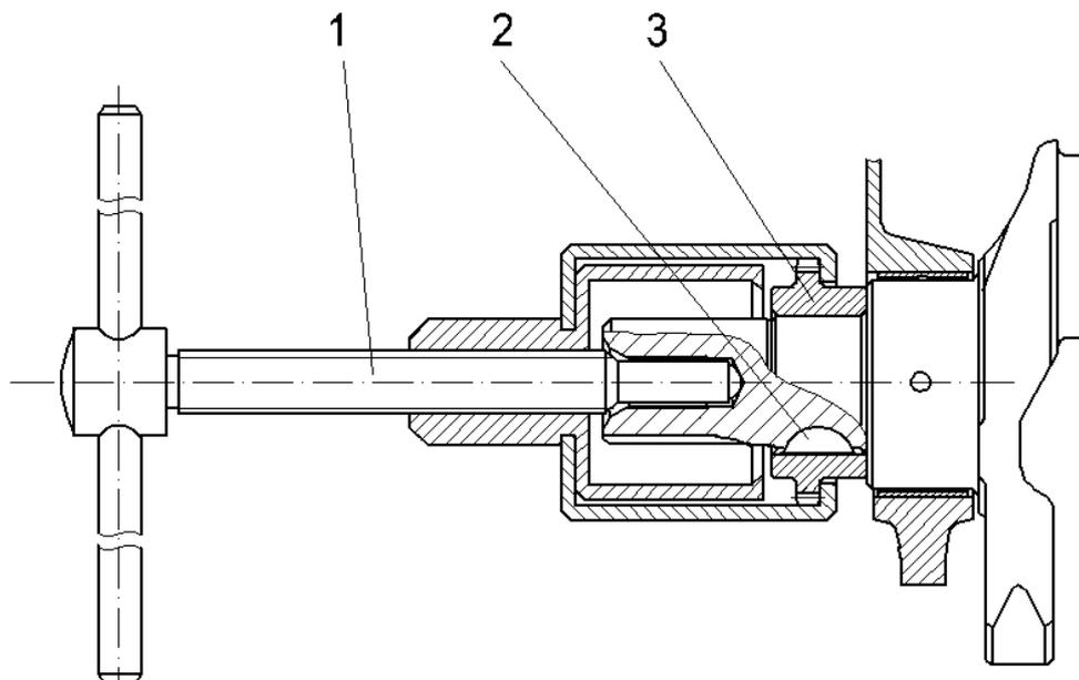
Рис.76. Снятие звездочки коленчатого вала:
