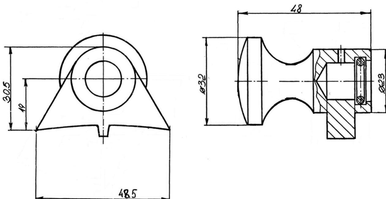
Рис.152. ЗМ 7820-4550, Фиксатор коленчатого вала
