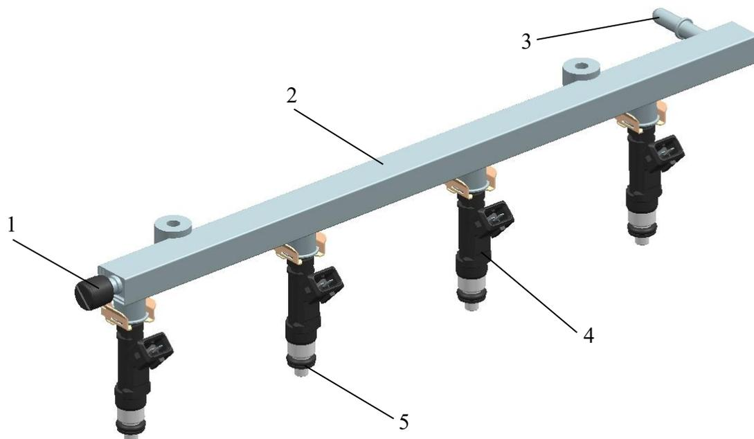
Рис.57. Топливная рампа с форсунками:
