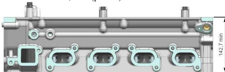
Рис.81. Минимальная высота головки цилиндров
