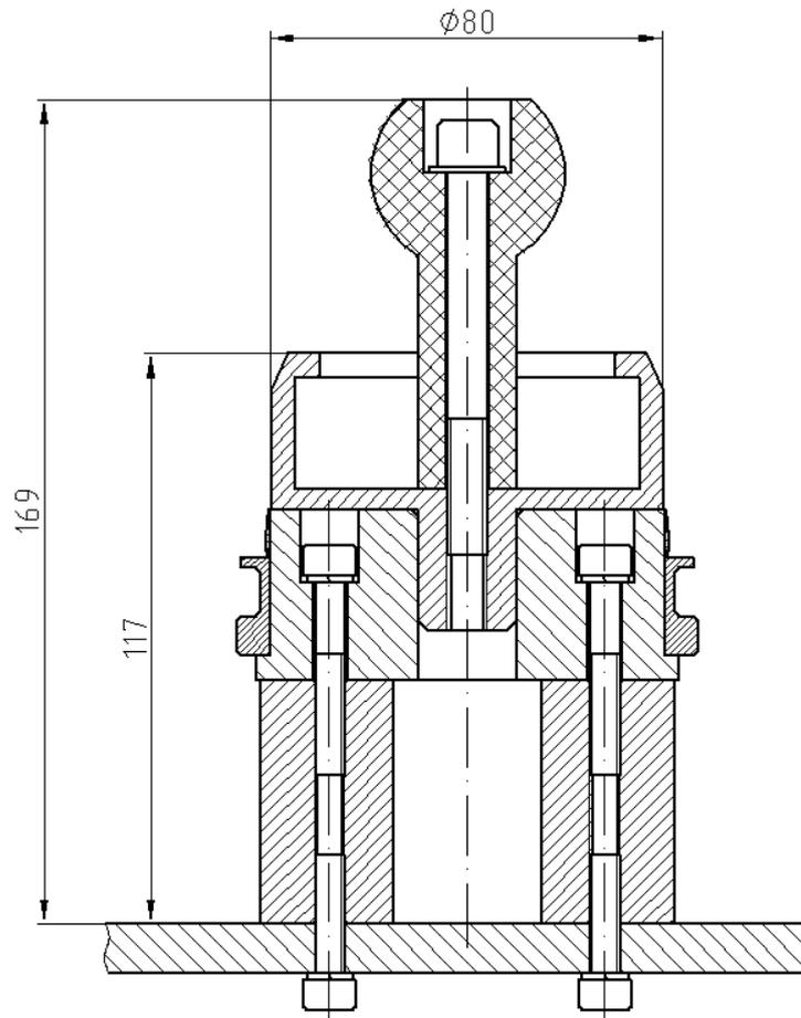
Рис.156. ЗМ 7820-4733, Приспособление для установки сальникодержателя с сальником без пружины
