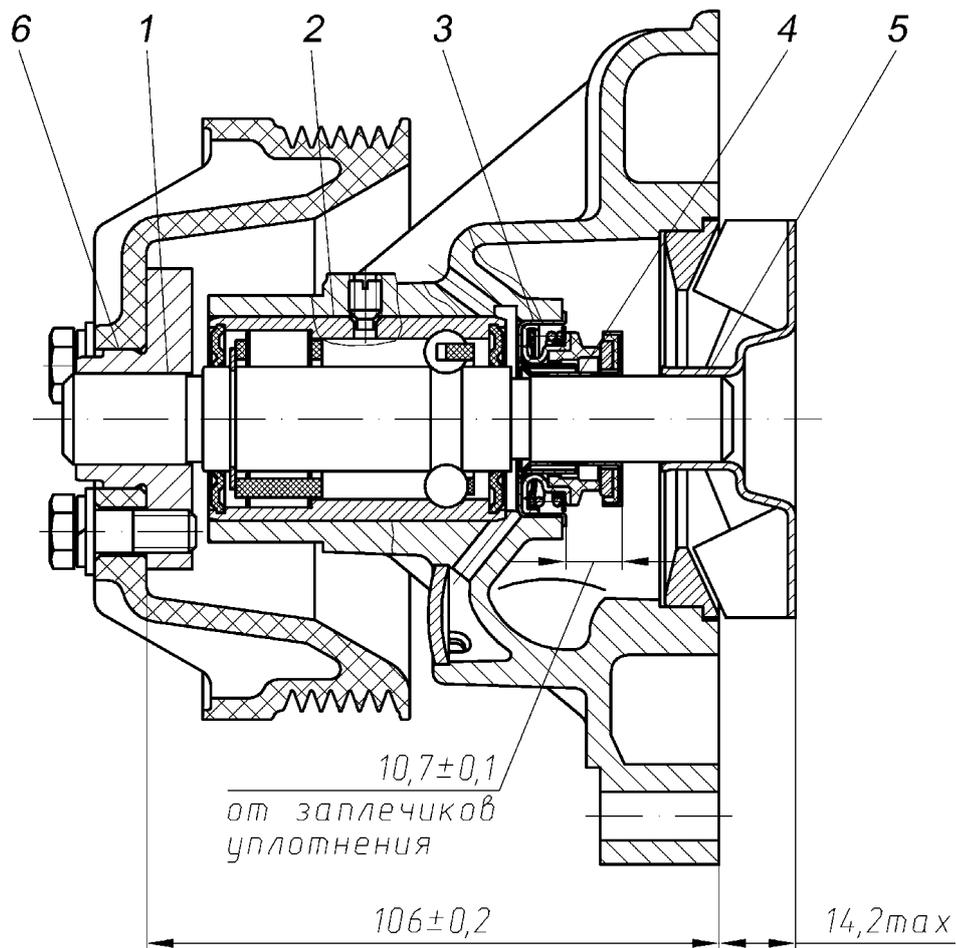
Рис.143. Водяной насос
