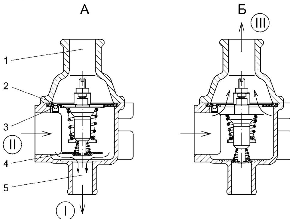
Рис.44. Схема работы термостата:
