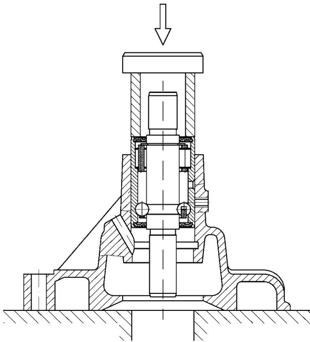
Рис.102. Запрессовка подшипника с валиком
