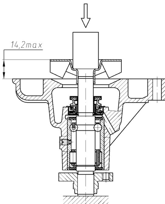
Рис.106. Напрессовка крыльчатки водяного насоса
