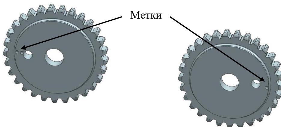
Рис.128. Звездочки распределительных валов
