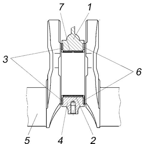
Рис.24. Средний (упорный) подшипник коленчатого вала:
