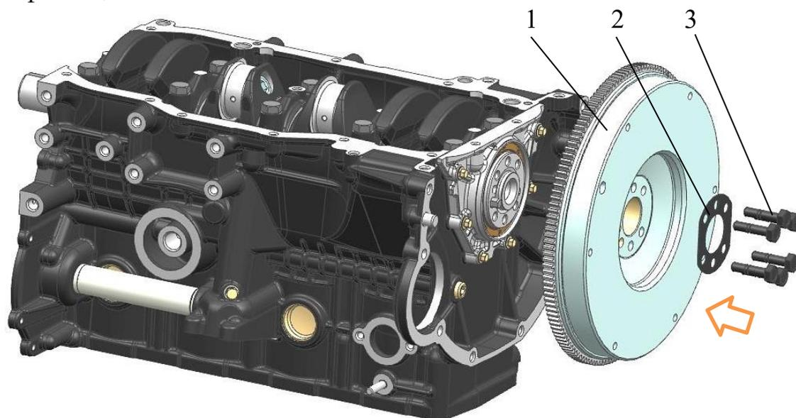
Рис.119. Установка маховика:
