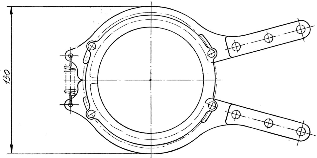
Рис.148. ЗМ 7814-5134, Клещи для снятия и установки поршневых колец  $\text{Ø} 95,5 \text{ мм}$
