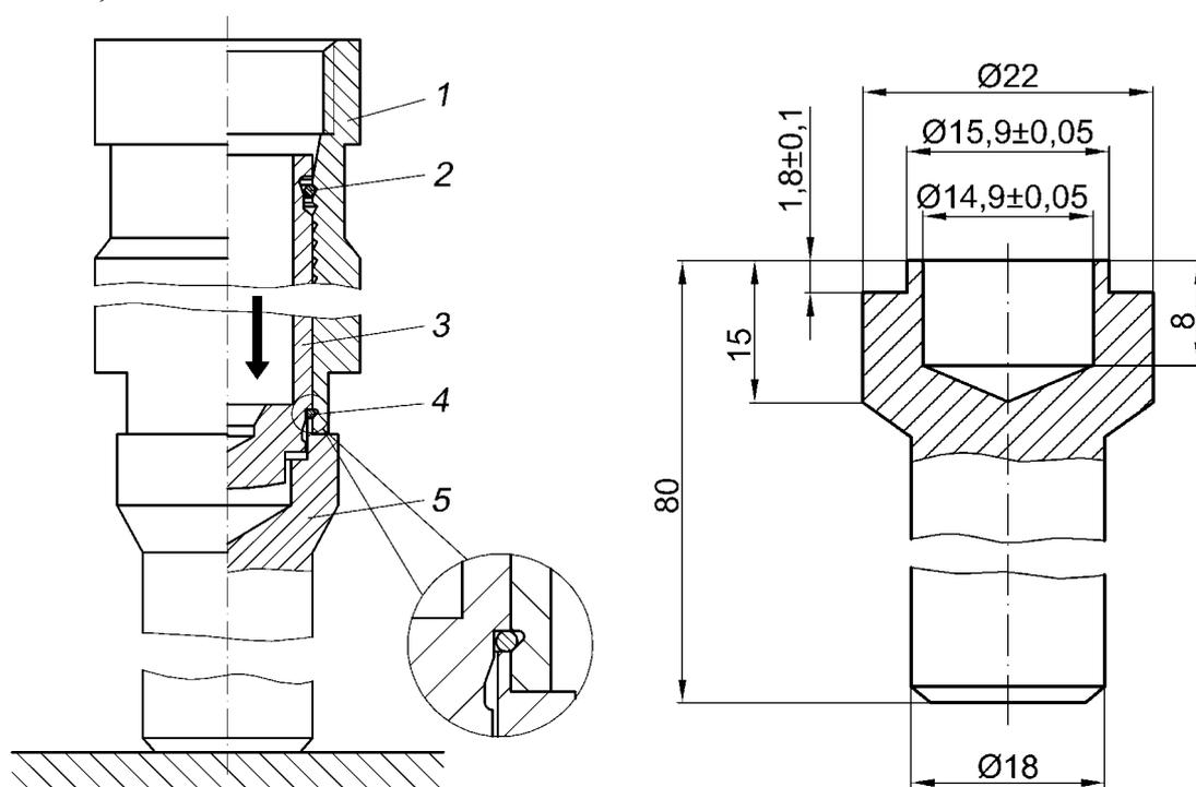
Рис.95. Сборка гидронатяжителя с помощью оправки:
