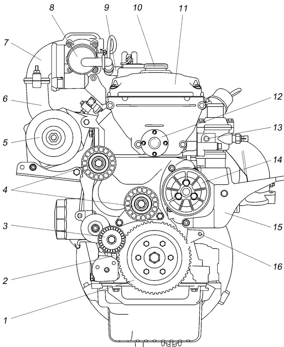
Рис.8. Вид спереди двигателя ЗМЗ-40904.10
