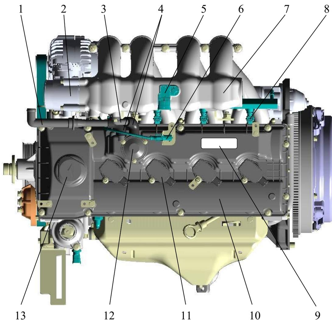
Рис.13. Вид сверху двигателя ЗМЗ-40905.10:
