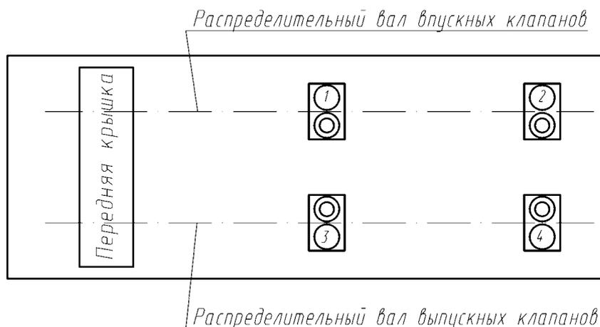
Рис.127. Схема установки крышек распределительных валов
