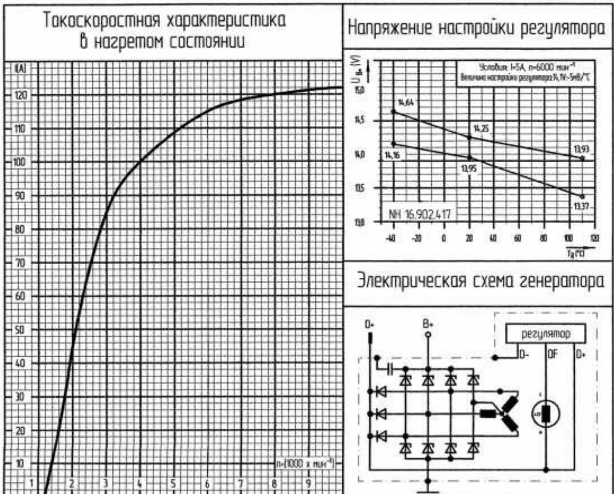
Рис.65. Габаритные размеры и токоскоростная характеристика генератора 5122.3771000-30 ООО «Промо-Электрo»
