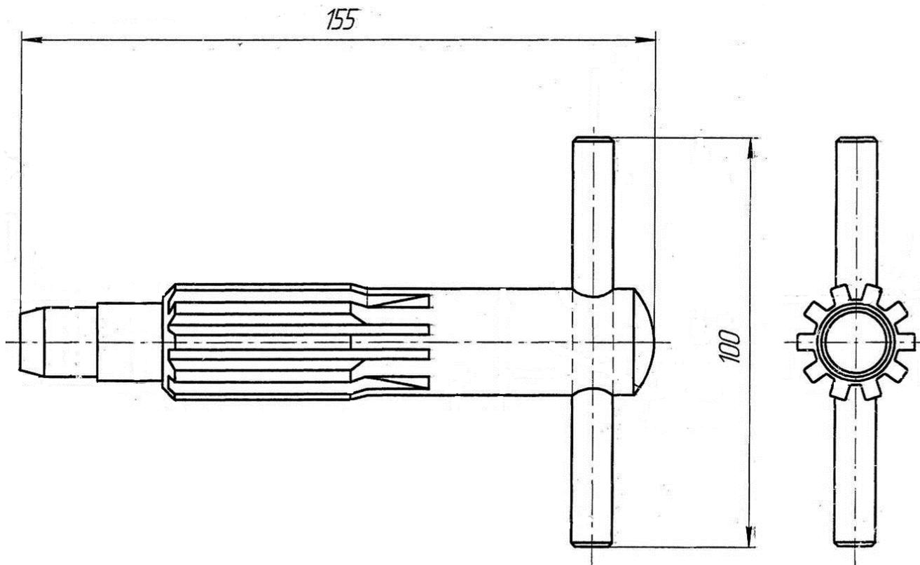
Рис.150. ЗМ 7853-4023, Оправка для центрирования ведомого диска сцепления
