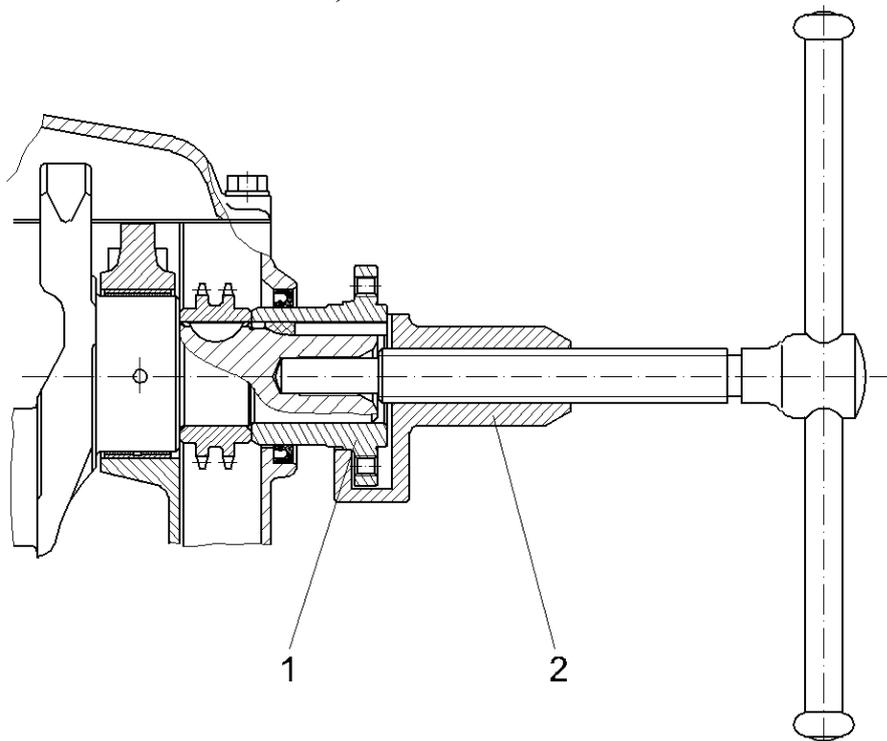
Рис.75. Снятие ступицы шкива коленчатого вала:
