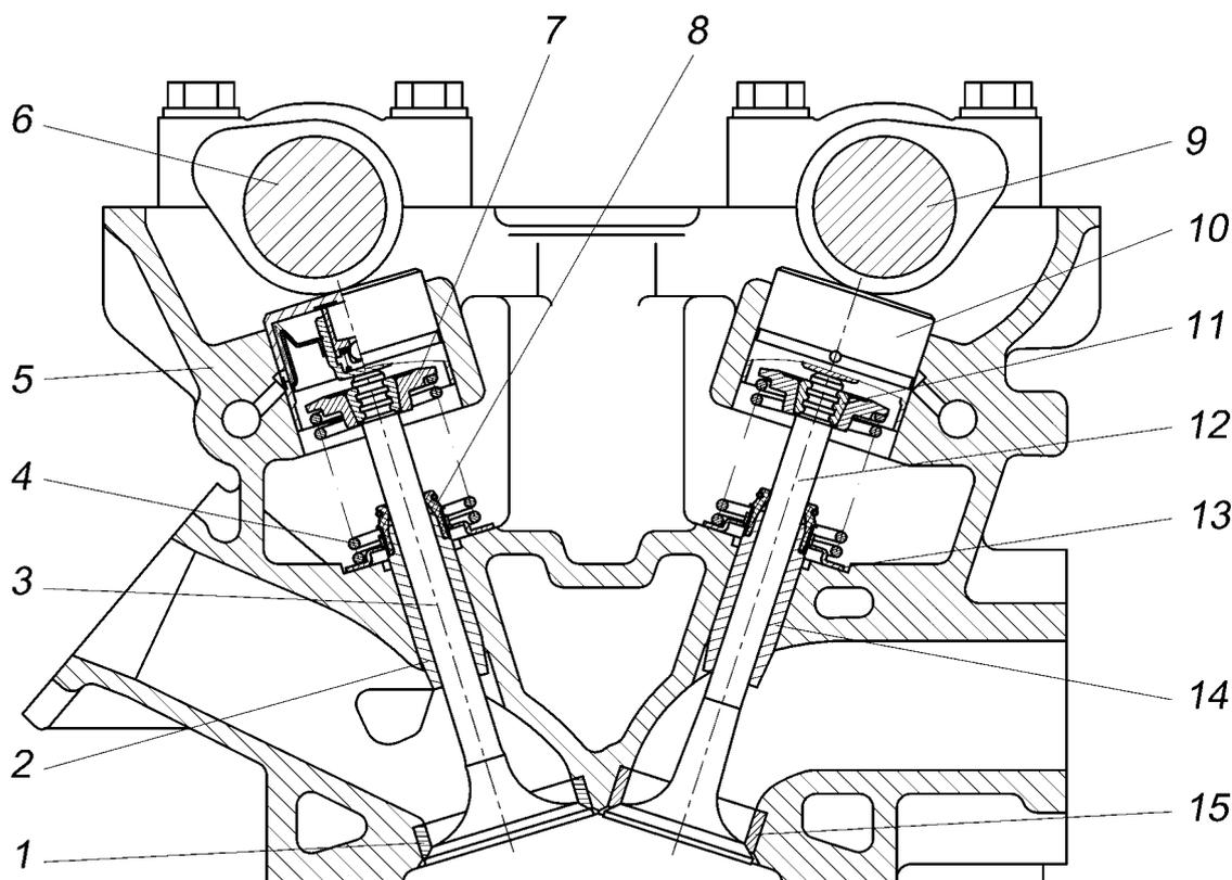
Рис.30. Привод клапанов:
