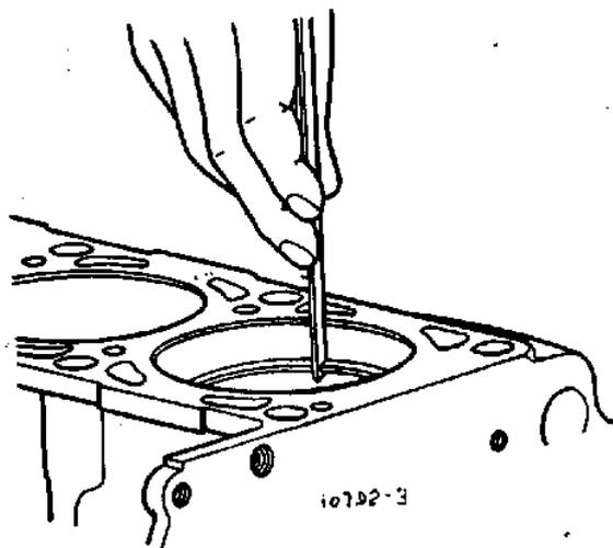
Рис.121. Замер теплового зазора в стыке поршневых колец
