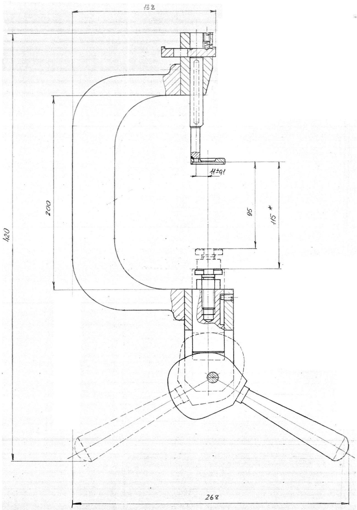
Рис.147. ЗМ 7814-5119, Приспособление для засухаривания и рассухаривания клапанов
