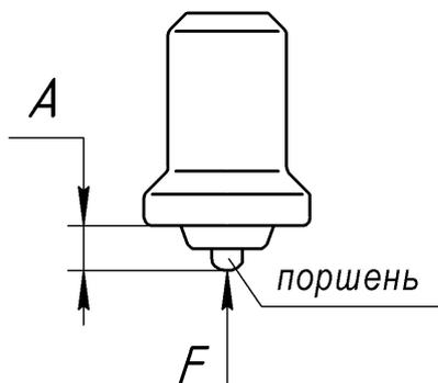
Рис.108. Проверка термосилового датчика
