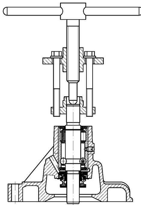
Рис.99. Снятие ступицы
