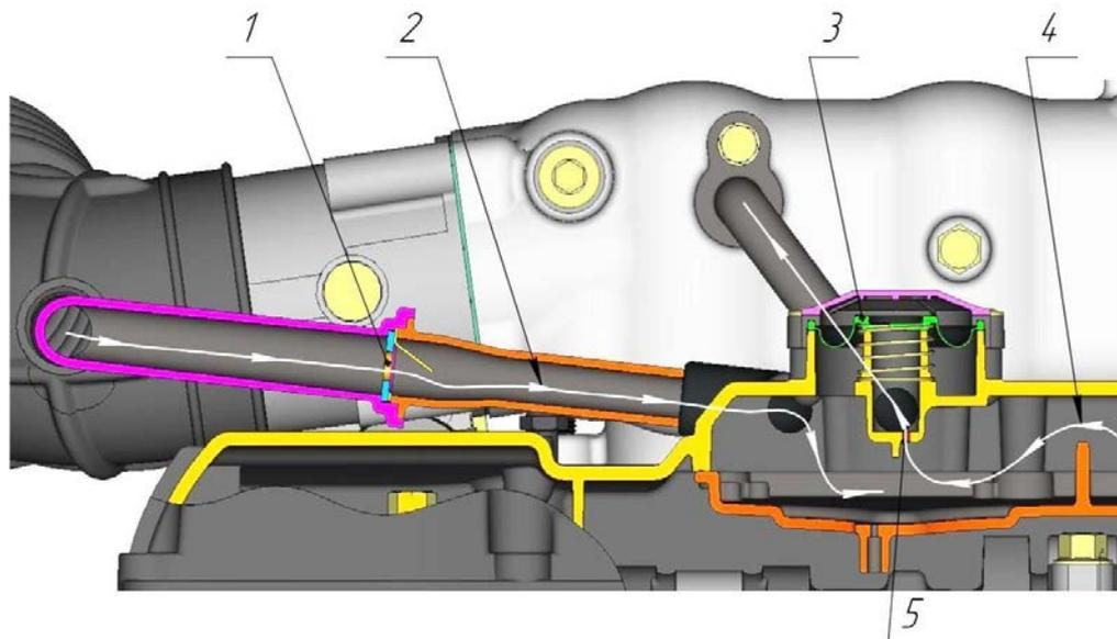
Рис.51. Состояние клапанов и движение потоков газов в системе вентиляции на холостом ходу:
