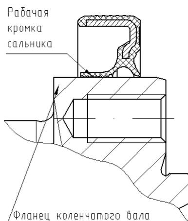
Рис.118. Ориентирование рабочей кромки на валу для сальника без пружины
