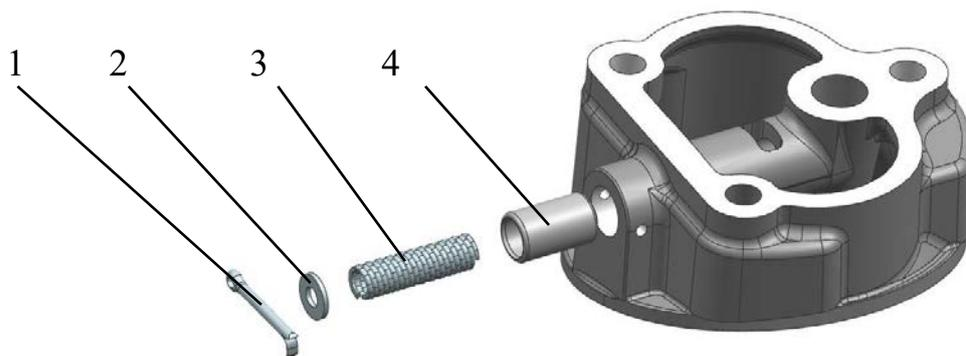
Рис.112. Разборка приёмного патрубка масляного насоса:
