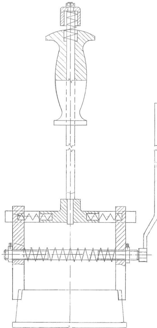
Рис.160. ЗМ 7814-5146, Съемник для снятия крышек коренных подшипников
