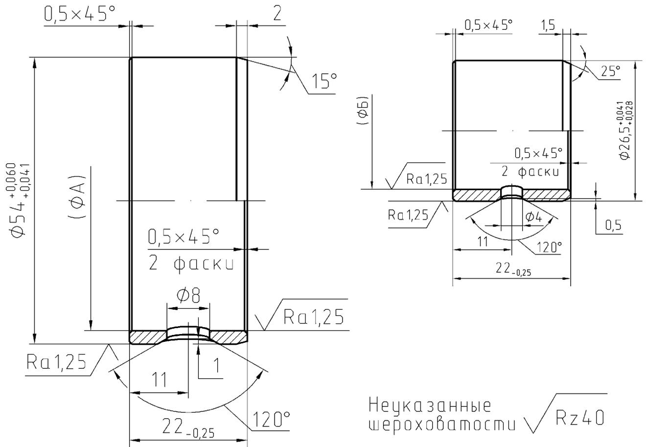
Рис.78. Ремонтные втулки опор промежуточного вала
