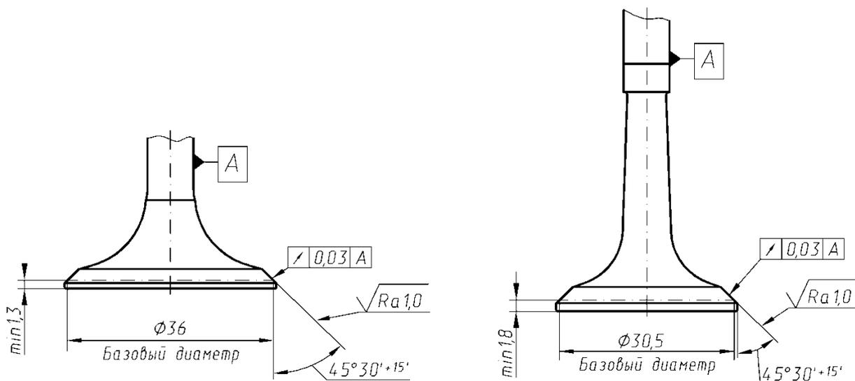
Рис.83. Обработка фасок клапанов
