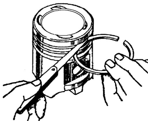
Рис.122. Проверка бокового зазора между поршневым кольцом и канавкой в поршне
