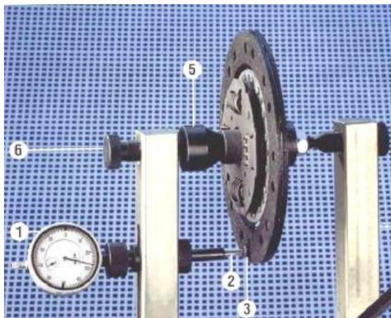
Рис.135. Проверка биения рабочей поверхности ведомого диска.
