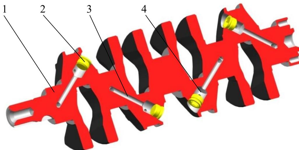
Рис.113. Пробки, каналы и грязеуловительные полости коленчатого вала:
