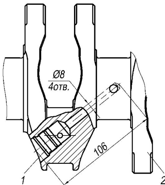
Рис.79. Удаление продуктов износа и нагара из полостей шатунных шеек коленчатого вала:
