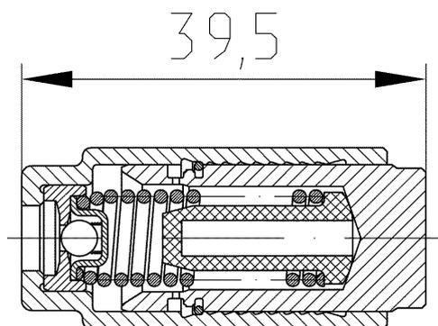
Рис.97. Положение плунжера при зарядке гидронатяжителя
