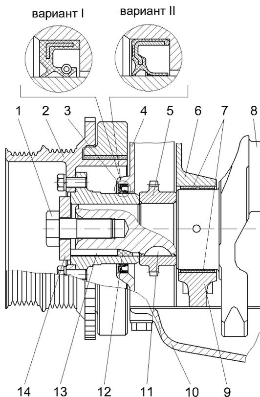
Рис.25. Передний конец коленчатого вала:
