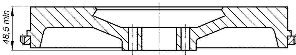
Рис.134. Предельный размер толщины маховика
