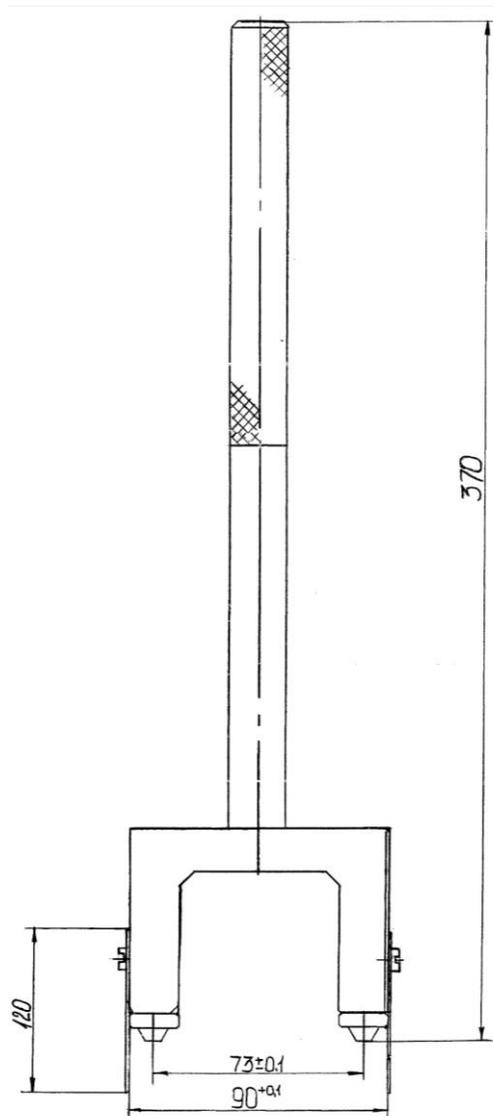
Рис.161. ЗМ 7823-4731, Оправка для демонтажа шатунно-поршневого комплекта из цилиндра
