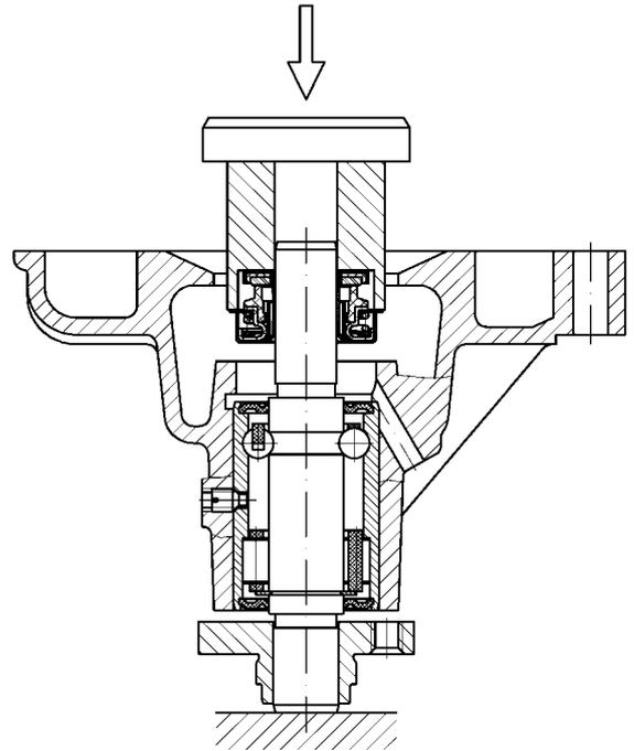
Рис.103. Запрессовка уплотнения водяного насоса
