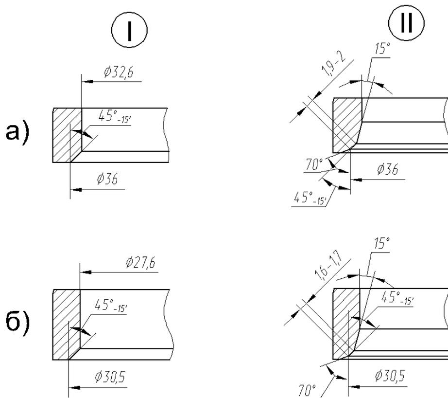
Рис.86. Обработка новых седел клапанов:
