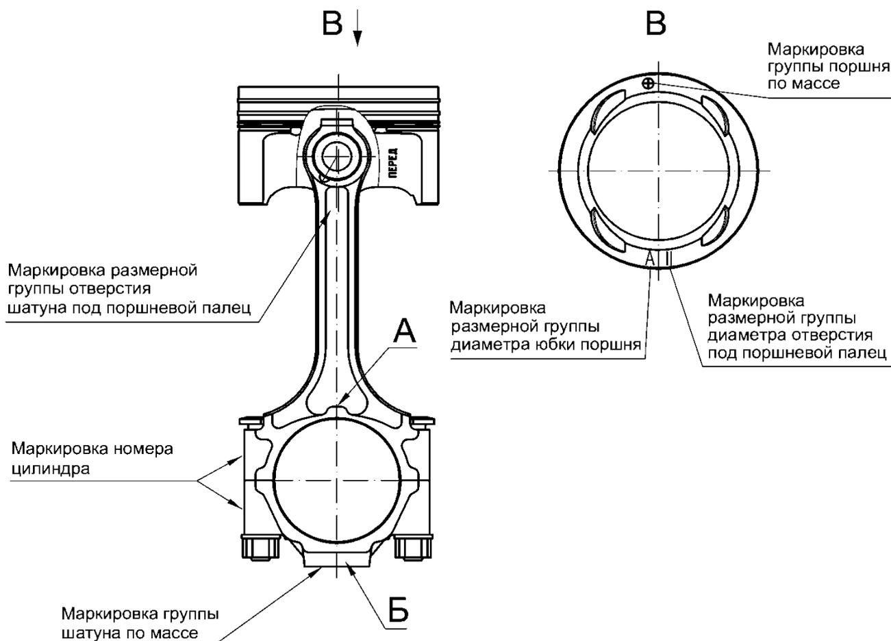
Рис.120. Маркировка шатуна и поршня
