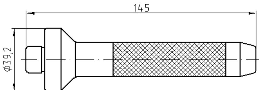
Рис.162. 5-У-10897, Оправка для запрессовки и выпрессовки подшипника первичного вала коробки передач
