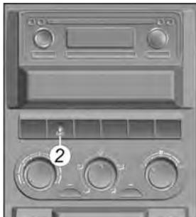
Выключатели имеют контрольные сигнализаторы включенного состояния.
