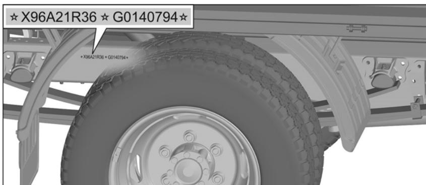
Пример нанесения VIN автомобиля и автомобильного шасси:
