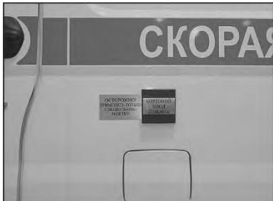
Бортовой ввод для подключения к внешнему источнику тока расположен снаружи автомобиля, в передней части левой боковины кузова. К бортовому вводу подключается розетка соединительного кабеля, а вилка с устройством защитного отключения на другом
