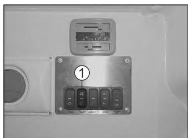
Включение ФВУ осуществляется клавишей 1, расположенной на панели управления дополнительным оборудованием, в верхней правой части перегородки между кабиной водителя и медицинским салоном со стороны медицинского салона. Вблизи клавиши включения ФВУ расположена информационная табличка «Вентиляция
