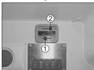
Для управления кондиционером (вариант исполнения I) используется регулятор скорости вращения вентилятора и термостат – регулятор температуры воздуха. Включение кондиционера и увеличение интенсивностью потока охлажденного воздуха осуществляется пе-
