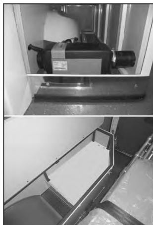
Возможна установка как одного, так и нескольких воздушных (автономных) отопителей медицинского салона, различных марок и мощности. Отопитель, в зависимости от комплекта поставки, может быть расположен в передней и/или задней части рундука по правому борту автомобиля и закрыт декоративными панелями.
