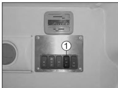
Клавиша управления отопителем 1 расположена на панели управления дополнительным оборудованием в верхней правой части перегородки между кабиной водителя и медицинским салоном со стороны медицинского салона и имеет два положения (две скорости вращения вентилятора). При включении отопителя на клавише загорается индикатор.
