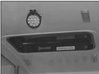
На крыше автобуса установлен аварийно-вентиляционный люк, предназначенный для приточно-вытяжной вентиляции салона при эксплуатации и запасного выхода в аварийной ситуации.
