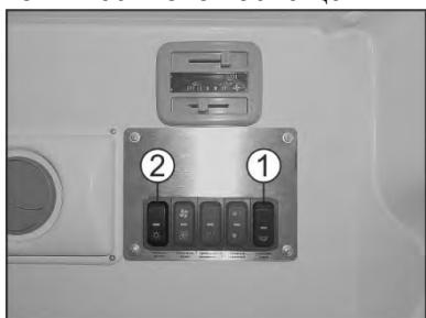
Включение/выключение общего освещения салона и плафонов местного освещения или светильника поворотного осуществляется клавишами 1 «Освещение салона» и 2 «Освещение местное», соответственно, расположеными на панели управления дополнительным оборудованием в верхней правой части перегородки между кабиной водителя и медицинским салоном со стороны медицинского салона.
