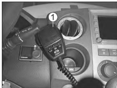
СГУ. СГУ включает в себя светоакустическую балку, расположенную на крыше в передней части автомобиля, проблесковые маяки, расположенные на крыше в задней части автомобиля, микрофон 1 с кнопками управления световыми и звуковыми сигналами и блок усиления сигнала микрофона
