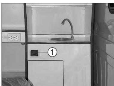
Основными элементами мойки являются кран, раковина с крышкой или без нее, бачок омывателя, канистра для использованной воды и кнопка 1 включения подачи воды.
