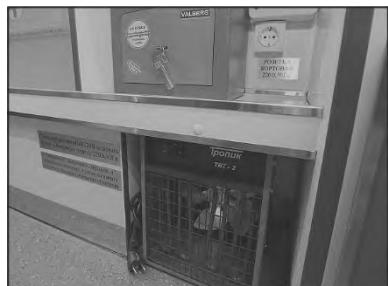
Для обогрева медицинского салона во время стоянки на открытой площадке автомобиль может быть оснащен (согласно комплекту поставки) стояночным отопителем. Стояночный отопитель работает от бортового ввода внешнего источника питания сети 220 В, 50 Гц с помощью кабеля внешнего подключения.
