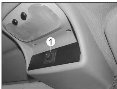
находится на центральной панели в кабине водителя. Поворот и наклон поисковой фары-прожектора осуществляется с помощью пульта управления 1 (джойстика), установленного в передней части панели потолка кабины водителя по центру.
