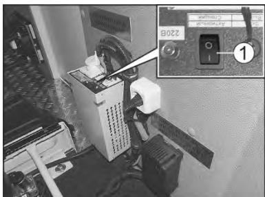
Включение преобразователя напряжения 12/220В осуществляется клавишей 1, расположенной на панели управления дополнительным оборудованием в медицинском салоне на перегородке между кабиной водителя и медицинским салоном со стороны медицинского салона справа сверху.
