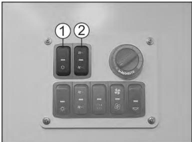
Для управления кондиционером (вариант исполнения II) используются клавиши 1 и 2 указанные на рисунке. Клавиша 1 включает кондиционер на первую скорость вращения вентилятора, клавиша 2 включает кондиционер на вторую и третью скорость, только при включенном положении клавиши 1. Для выключения кондиционера необходимо перевести клавиши 1 и 2 в среднее положение.
