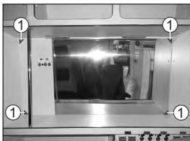
Закладная пластина для крепления дополнительного медицинского оборудования расположена по левому борту автомобиля под декоративной панелью медицинского салона. Границы пластины указаны стикерами 1 «Красный уголок».
