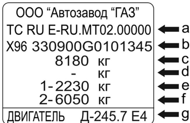
Рис. 1.5. Пример заводской таблички с паспортными данными автомобиля ГАЗ-3309:
