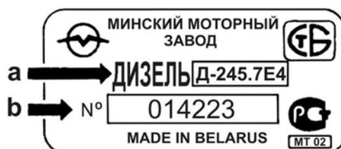
Рис. 1.3. Пример нанесение номера двигателя ММЗ Д-245.7 Е4
