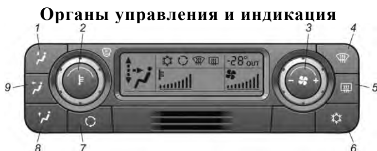
Рис. 8.1. Пульт управления отопительно-вентиляционной и климатической установкой
