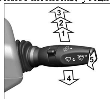
Рис. 5.6а. Рычаг переключателя стеклоочистителя и стеклоомывателя с регулятором паузы (вариант 1)
