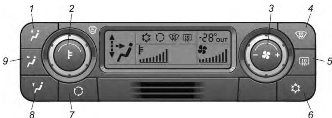
Рис. 8.1. Пульт управления отопительно-вентиляционной и климатической установкой
