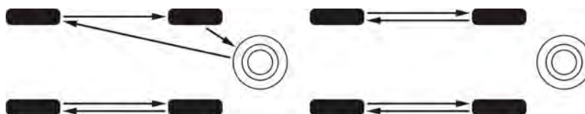
Рис. 9.9. Схема перестановки шин
