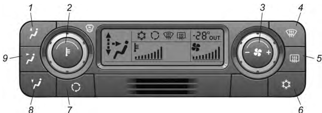
Рис. 8.1. Пульт управления отопительно-вентиляционной и климатической установкой
