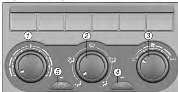
Рис. 8.5. Пульт управления отоплением, вентиляцией и кондиционированием воздуха
