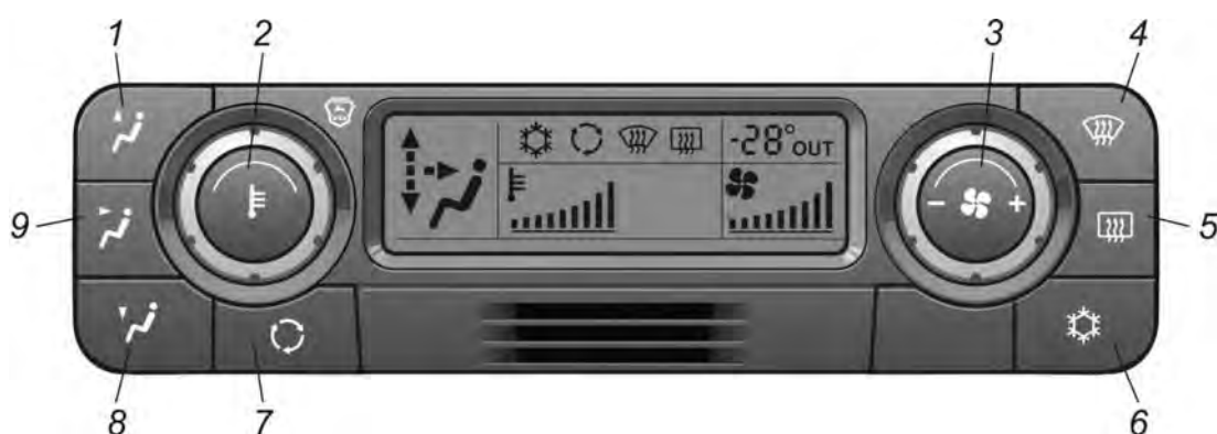
Рис. 8.1. Пульт управления отопительно-вентиляционной и климатической установкой
