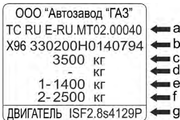
Рис. 1.6. Пример заводской таблички с паспортными данными, где:
