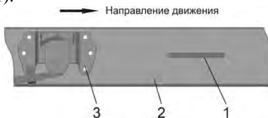
Рис. 1.2. 1 – место нанесения VIN автомобилей с платформой и их шасси; 2 – лонжерон рамы правый; 3 – передний кронштейн задней рессоры
