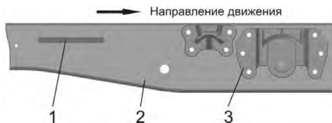
Рис. 1.3. 1 – место нанесения VIN автомобилей с платформой и их шасси; 2 – лонжерон рамы правый; 3 – передний кронштейн задней рессоры
