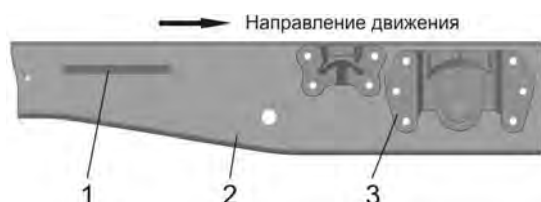
Рис. 1.1. 1 – место нанесения VIN автомобилей ГАЗ-33026 и мод. с платформой и их шасси; 2 – лонжерон рамы правый; 3 – передний кронштейн задней рессоры
