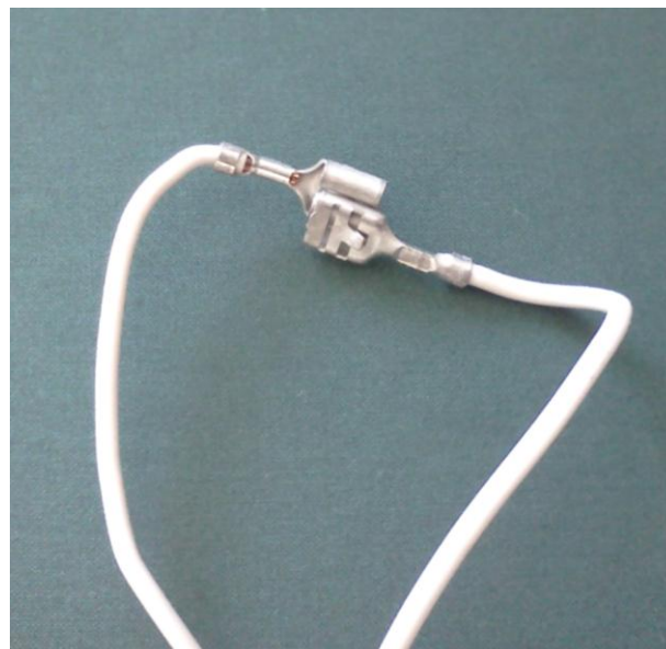
Рис.6а – Замкнутые провода
