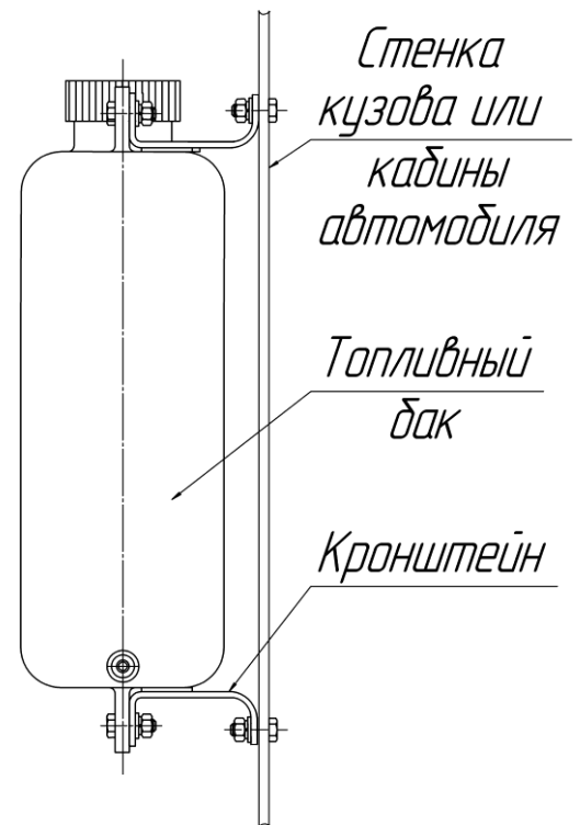
Рис. 8.3 - Установка топливного бака на автомобиль.
