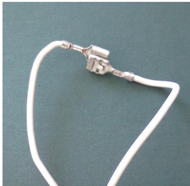
Рис.6а – Замкнутые провода
