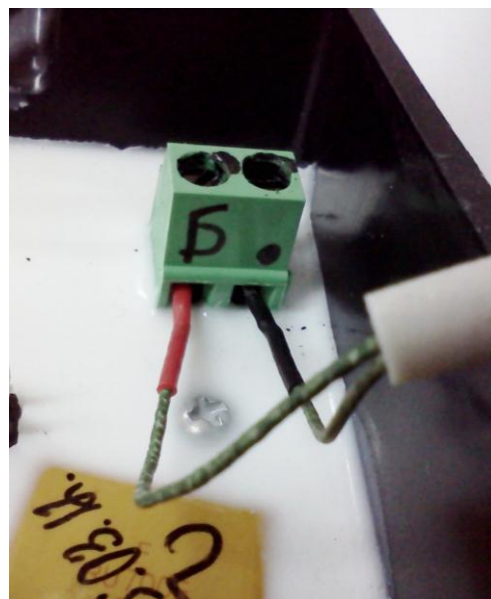
Рис.6б - Подключение ИП к БУ
