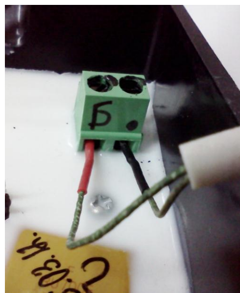
Рис.6б - Подключение ИП к БУ
