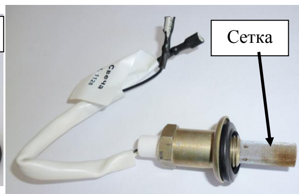
Рис.2а – Свеча с монтажным комплектом (для бензинового подогревателя)
