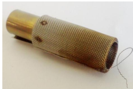
Рис.3б – Заусенец на сетке
