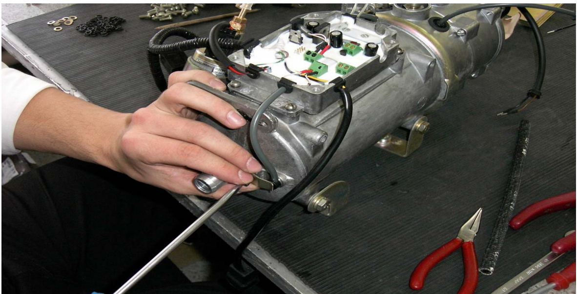
Рис.14- Установка и демонтаж датчика перегрева
