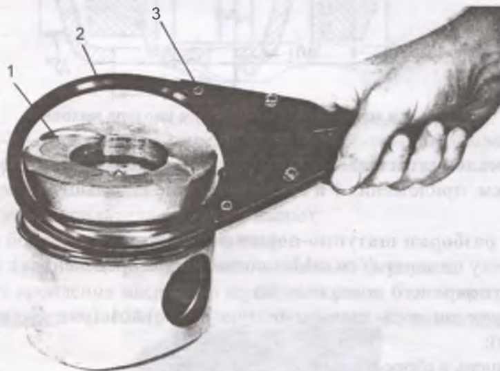
Снятие поршневых колец съемником И801.08.000
