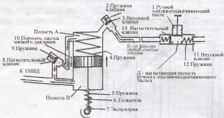
Схема работы топливного насоса низкого давления и насоса предпусковой прокачки топлива
