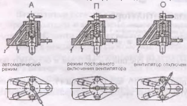
Положение выключателя гидромуфты привода вентилятора
