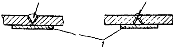
Рис. 367. Заварка сквозных трещин
